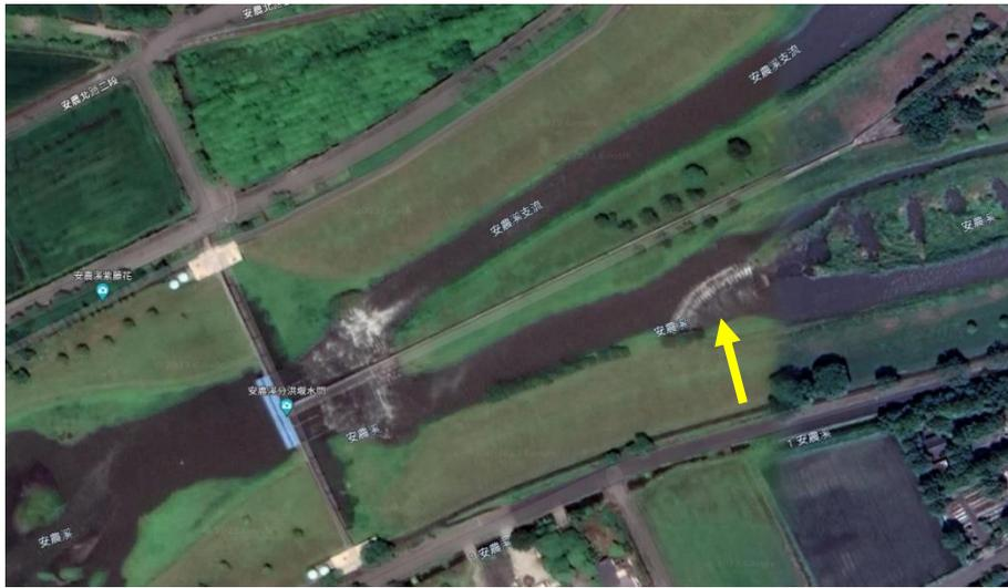
照片 3-2 安農溪分洪堰右側分洪道取水工阻水
