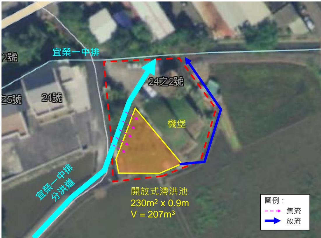
圖 6-17 進士里飛機掩體 1 號基地逕流分擔措施初步配置圖
