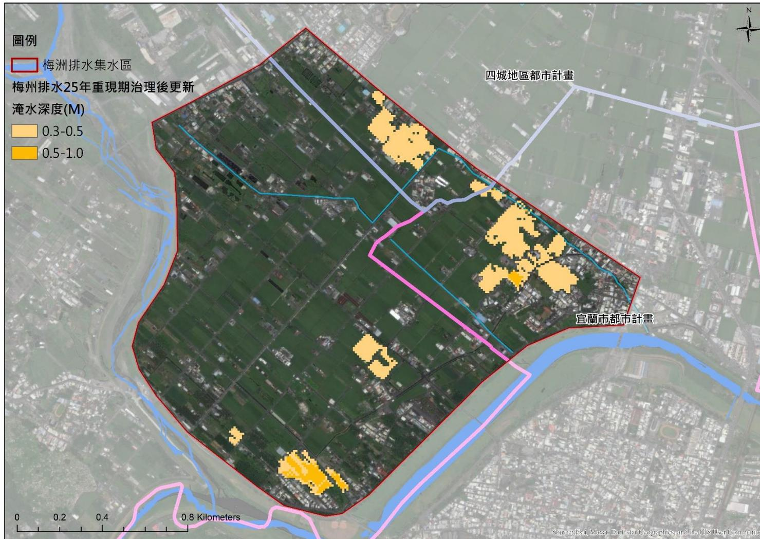
圖 4-4 梅洲排水系統(治理計畫工程完成後)評估降雨事件情境淹水模擬與都市計畫區套繪圖
