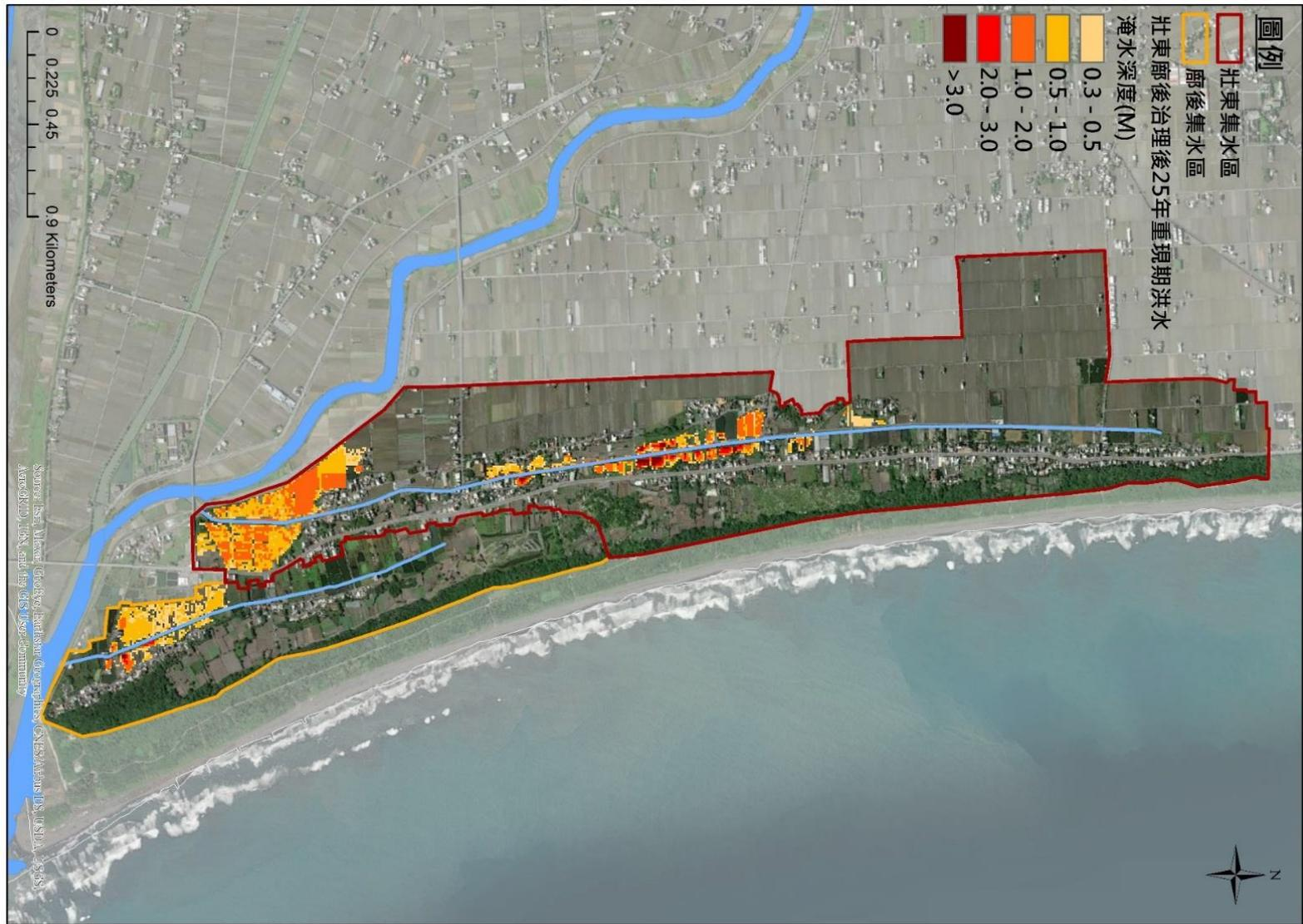
圖 3-65 壯東一大排及廟後排水評估水文情境淹水模擬圖(治理計畫工程完成後)
