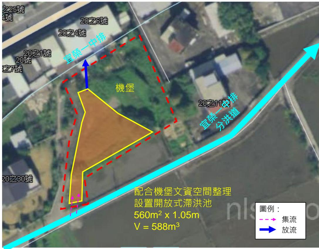
圖 6-18 進士里飛機掩體 2 號基地逕流分擔措施初步配置圖
