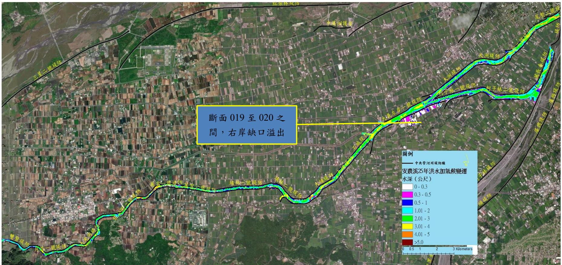
圖 3-50 安農溪評估水文情境下之區域淹水潛勢面積及體積分配示意圖(治理計畫工程完成後)
