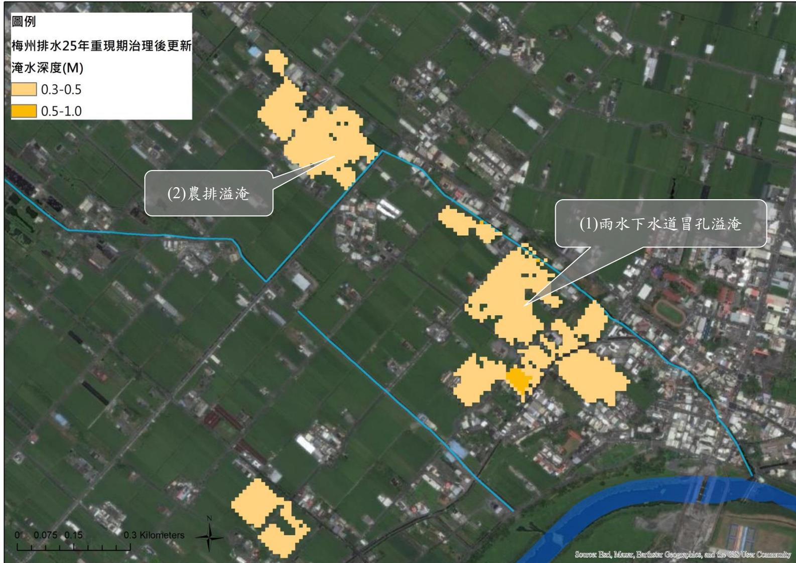
圖 3-62 梅州排水系統評估水文情境淹水模擬詳圖(1)(治理計畫工程完成後)
