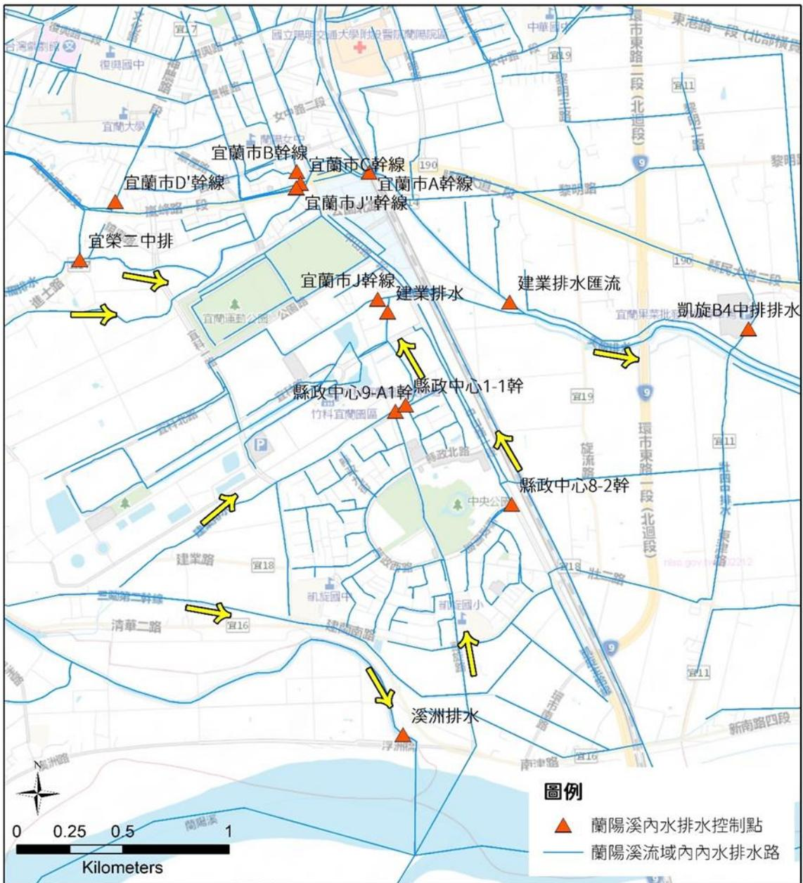
圖 3-33 美福排水系統(高速公路以西)流量控制點位置圖
