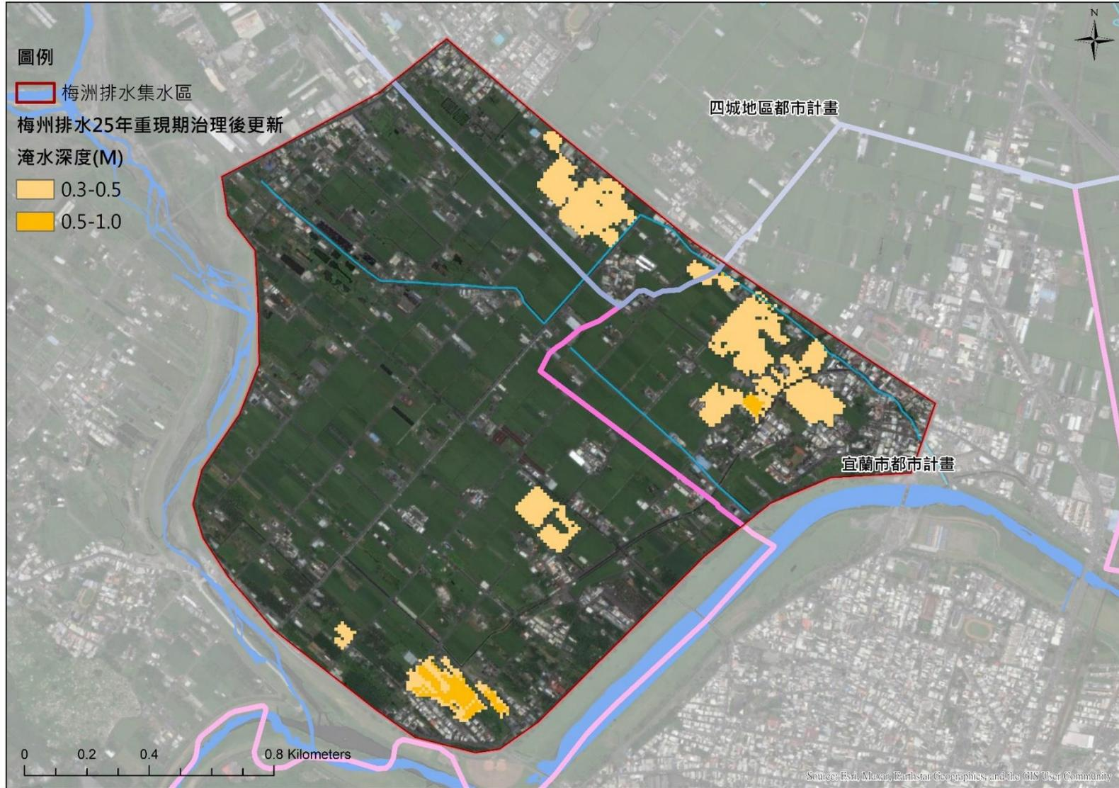
圖 3-61 梅洲排水系統評估水文情境淹水模擬圖(治理計畫工程完成後)
