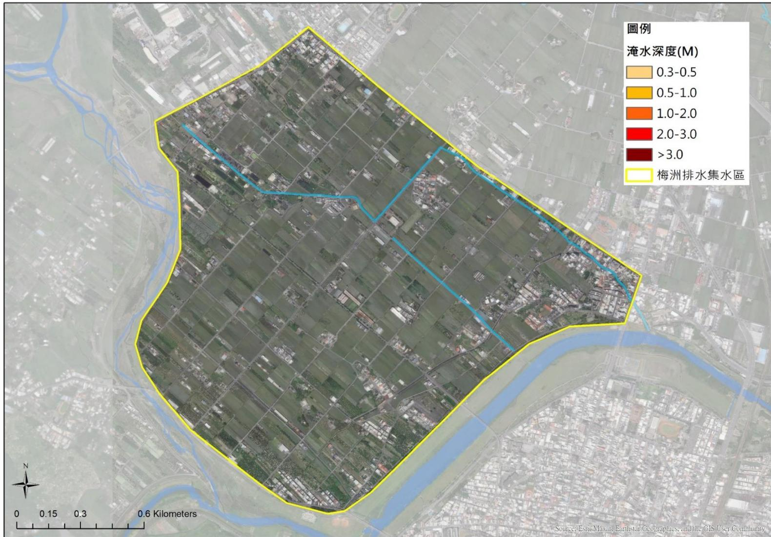
圖 3-60 梅洲排水系統計畫流量情境淹水模擬圖(治理計畫工程完成後)
