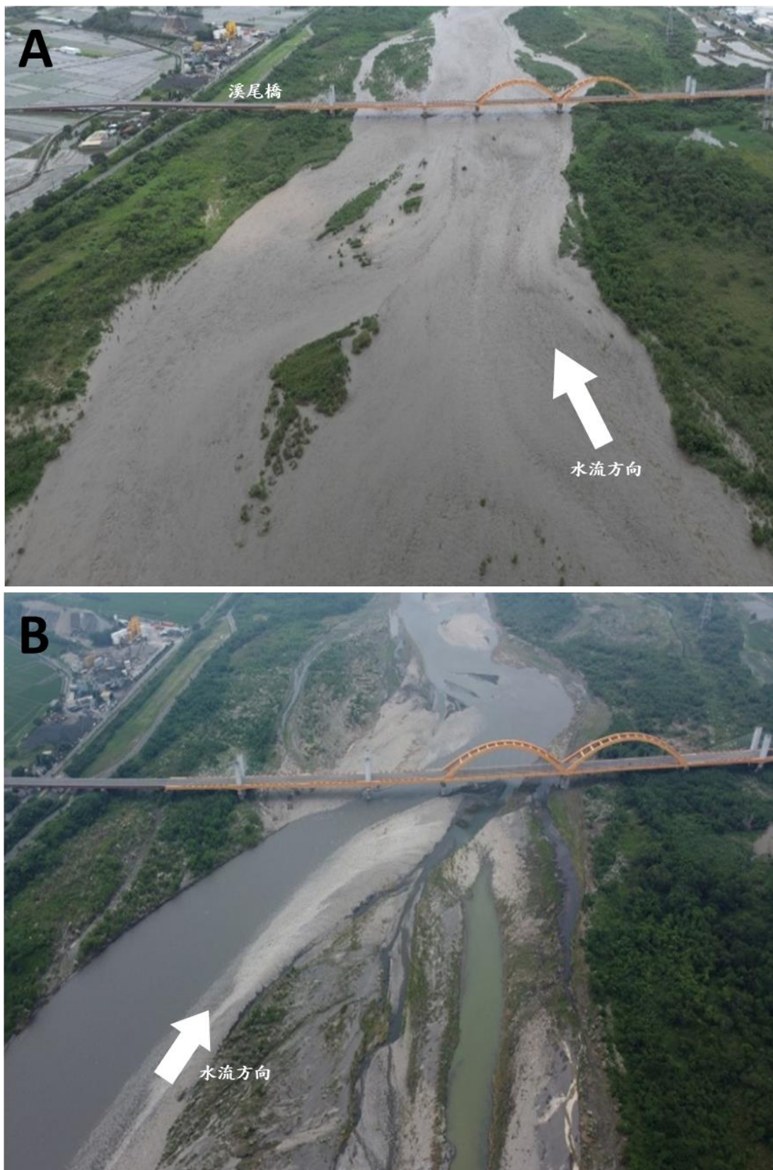
圖 4-5、溪尾橋辮狀河川流路變化。颱風期間，因強降雨造成溪尾橋原本的辮狀河川變成單一流路（A：2023/08/04）；颱風後約一個月，慢慢恢復為多重流路的情形（B：2023/08/30）。
