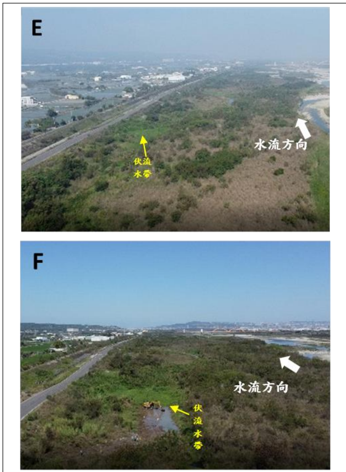
圖 3-2、伏流水區湧泉判定與搜尋方式案例（續）。烏溪溪尾橋右岸高灘地可見綠色植生帶（E），經開挖後可見豐沛的湧泉（F）。
