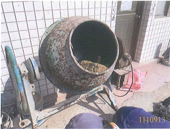
280kgfcm<sup>2</sup>(II)混凝土人工試拌
