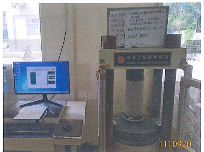
280kgfcm<sup>2</sup>(II)混凝土抗壓試驗(7天)
