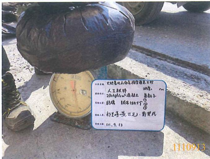
280kgfcm<sup>2</sup>(II)混凝土人工試拌
