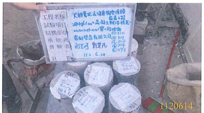
280kgfcm<sup>2</sup>(II)混凝土抗壓試驗(28天)
