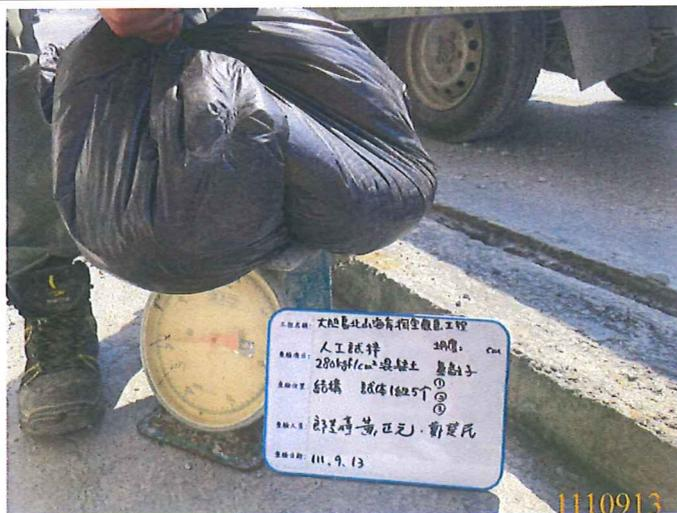
280kgfcm<sup>2</sup>(II)混凝土人工試拌
