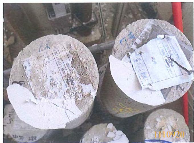
280kgfcm<sup>2</sup>(II)混凝土抗壓試驗(7天)
