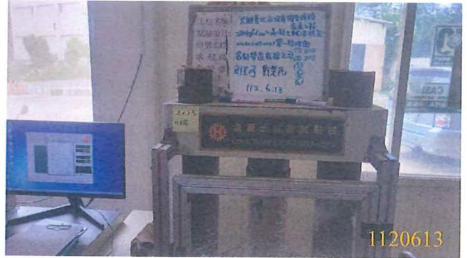
280kgfcm<sup>2</sup>(II)混凝土抗壓試驗(28天)
