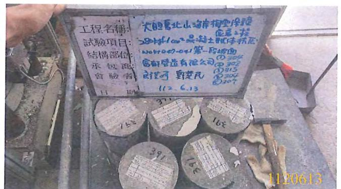
280kgfcm<sup>2</sup>(II)混凝土抗壓試驗(28天)
