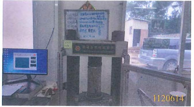
280kgfcm<sup>2</sup>(II)混凝土抗壓試驗(28天)
