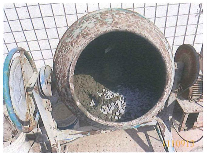
280kgfcm<sup>2</sup>(II)混凝土人工試拌
