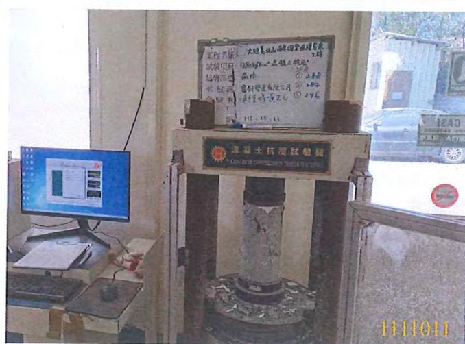
280kgfcm<sup>2</sup>(II)混凝土抗壓試驗(28天)
