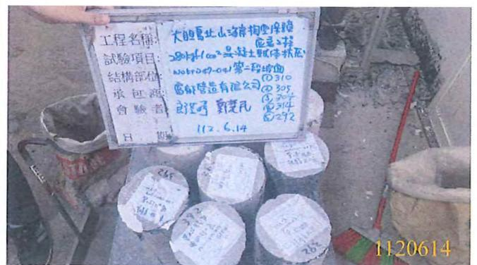
280kgfcm<sup>2</sup>(II)混凝土抗壓試驗(28天)
