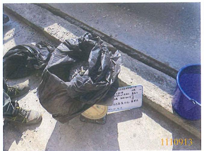
280kgfcm<sup>2</sup>(II)混凝土人工試拌
