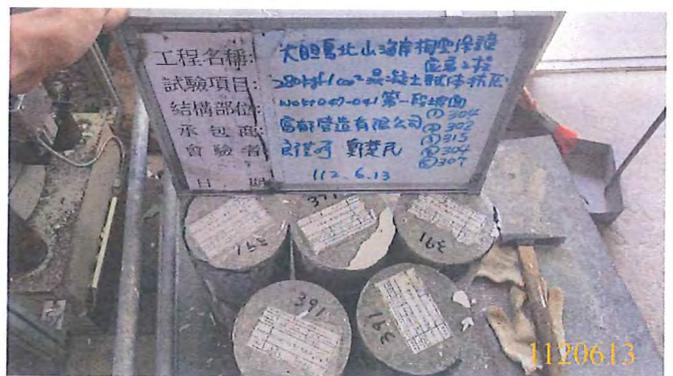
280kgfcm<sup>2</sup>(II)混凝土抗壓試驗(28天)
