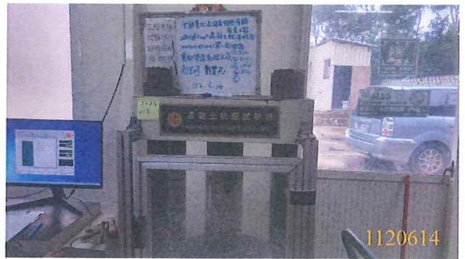
280kgfcm<sup>2</sup>(II)混凝土抗壓試驗(28天)
