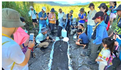
操作以現地材料製作的簡易水工模型
