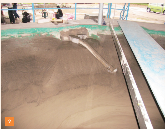
1 1/100 石門水庫全模型布置圖 2 排洪隧道單管象鼻防淤鋼管研發測試 3 1/100 模型試驗成果 - 異重流通過電廠流態
