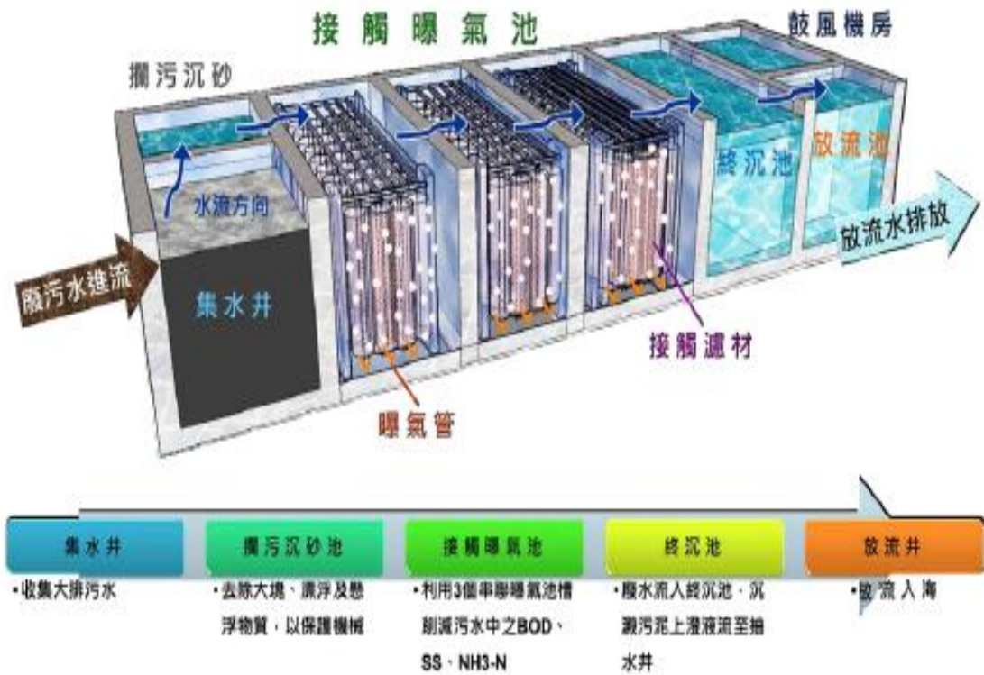
圖 12 簡易場鑄式污水處理設施及處理流程示意圖
