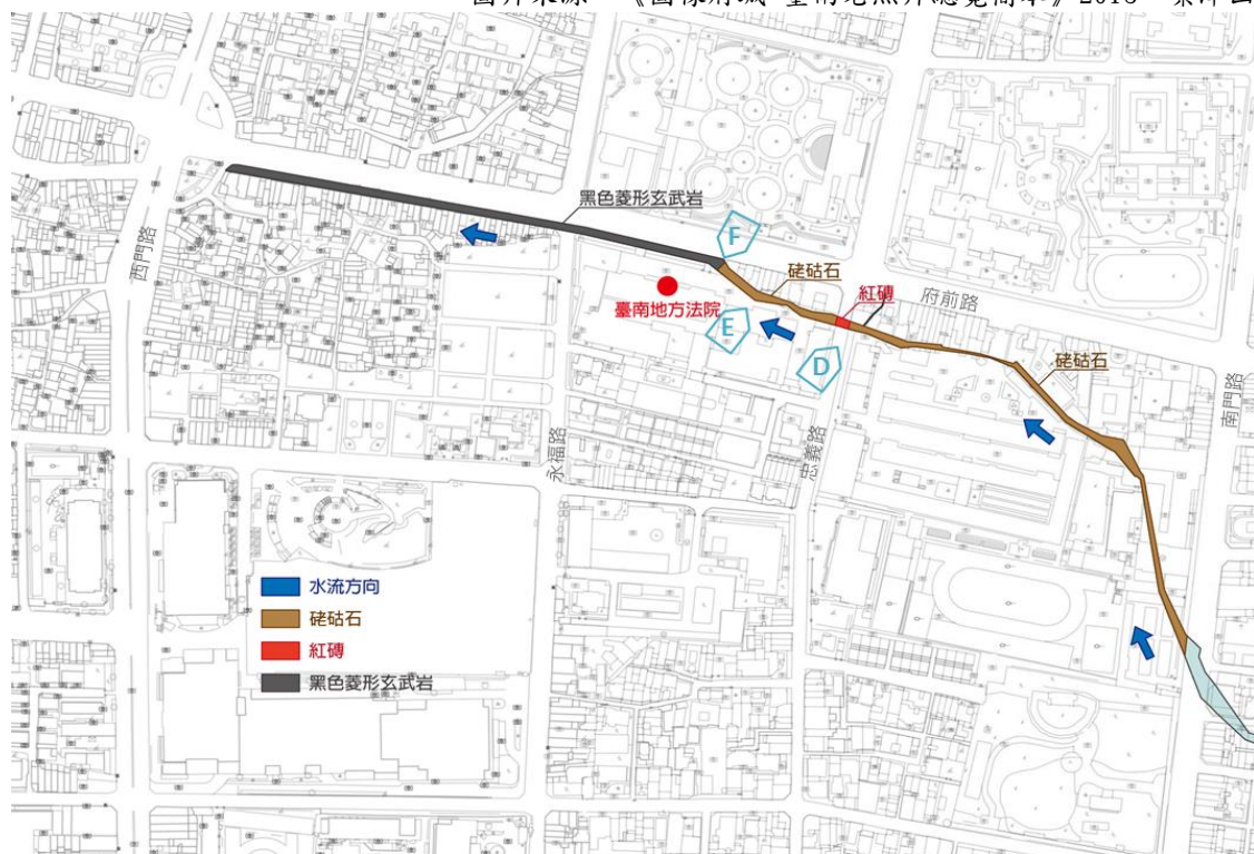
圖 9 日治時期市區改正後之福安坑溪溝體材料、河溝位置圖
