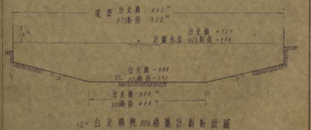
圖 5.6 淡水河及大嵙崁溪計劃河槽断面圖 (第一案)
