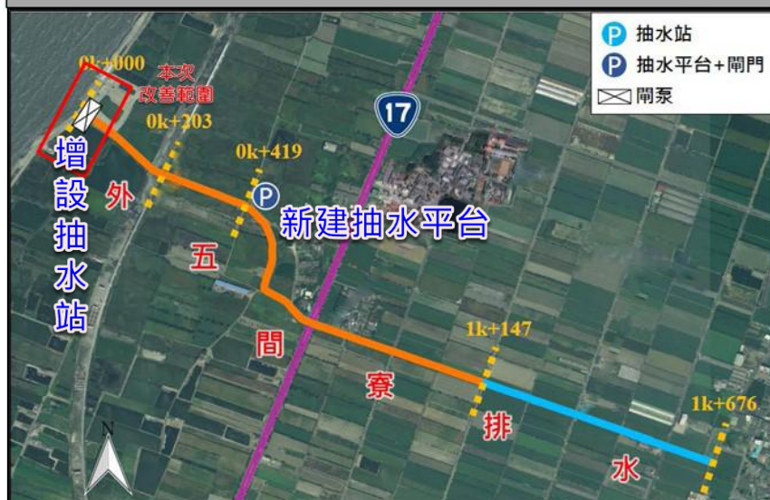
外五間寮排水治理工程配置圖
