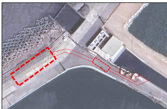
新設抽水站、排水箱涵及沉砂池
