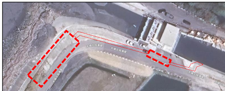
新設抽水站、排水箱涵及沉砂池
