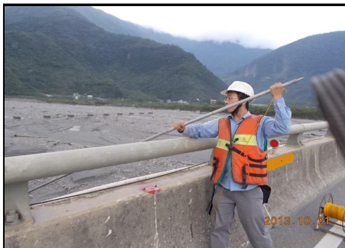
說明： 項目：流速及流量 日期：102.10.21 (11:30) 地點：大濁水橋
