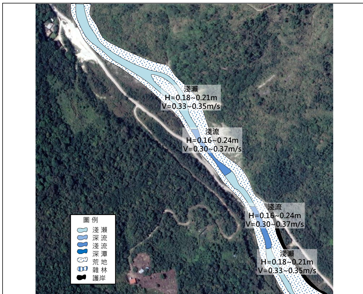
圖 3-13 澳花橋上游過水路面樣站各棲地流速及水深資料概圖
