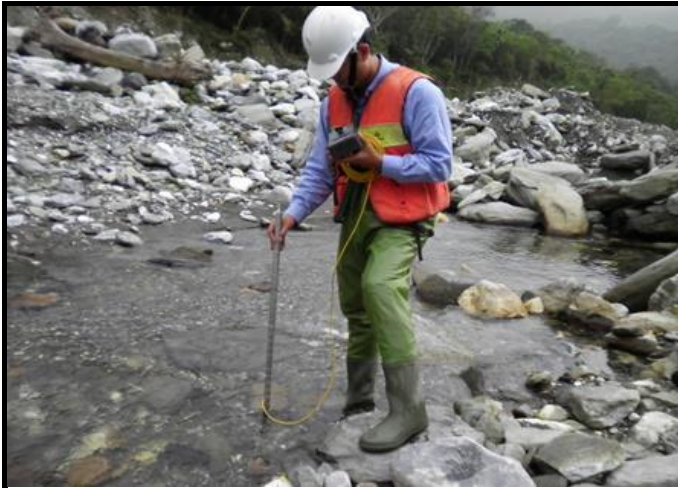
說明： 項目：流速及流量 日期：102.03.28 (11:38) 地點：澳花橋上游過水路面
