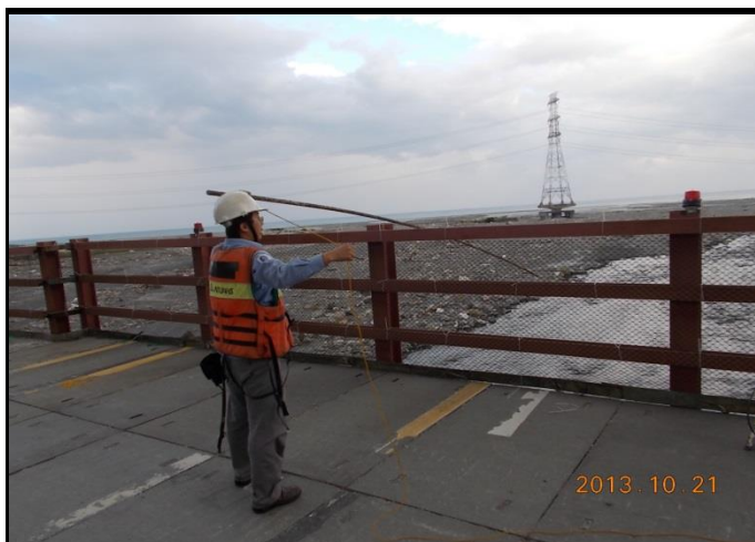
說明： 項目：流速及流量 日期：102.10.21 (14:20) 地點：出海口
