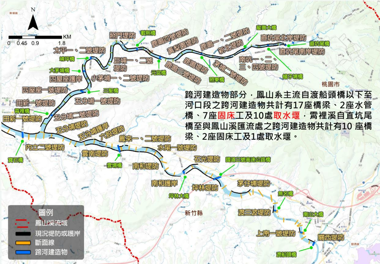
跨河建造物部分，鳳山系主流自渡船頭橋以下至河口段之跨河建造物共計有17座橋梁、2座水管橋、7座固床工及10處取水堰，霄裡溪自直坑尾橋至與鳳山溪匯流處之跨河建造物共計有10座橋梁、2座固床工及1處取水堰。
