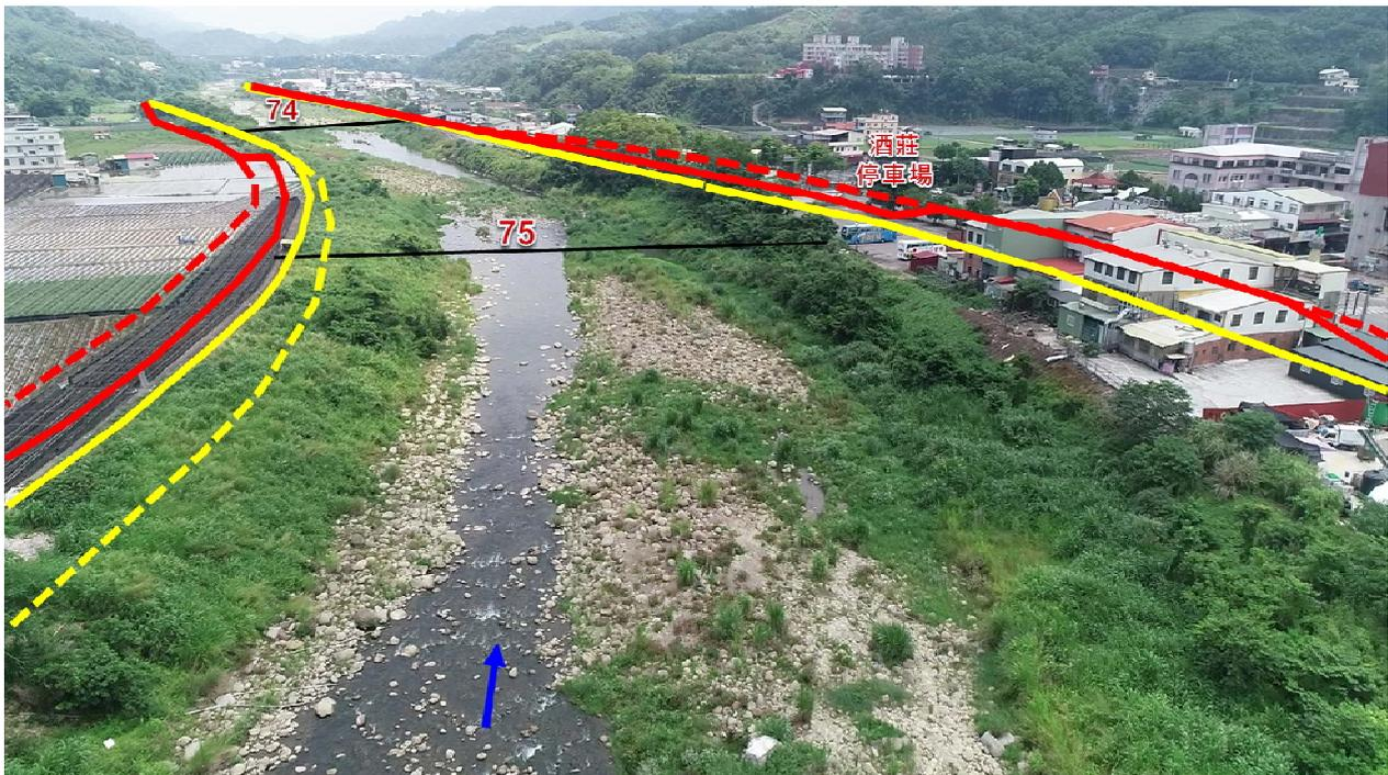
圖 3-4 斷面 74~75 上游兩岸治理計畫線及用地範圍線修正情形
