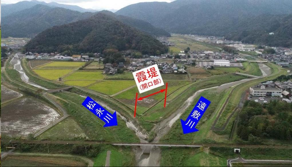
日本於河川設置霞堤，將水引入鄰近田地，並由缺口處進行退水，減少洪災損失
