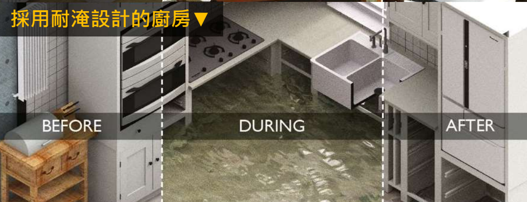
利用室內空間配置轉換，即可使建築物具耐淹能力
