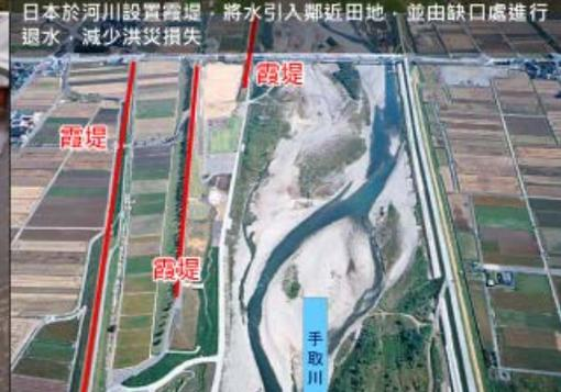
日本於河川設置露堤，將水引入鄰近田地，並由缺口處進行退水，減少洪災損失
