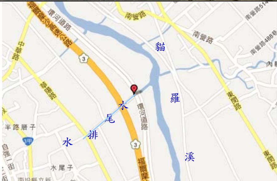
貓羅溪左岸支流水尾排水(約斷面26左岸)，排水下游出口為三孔箱涵排入貓羅溪，現況排水出口已設置閘門，排水下游出口渠道現況局部淤積，建請權責單位辦理清淤。
