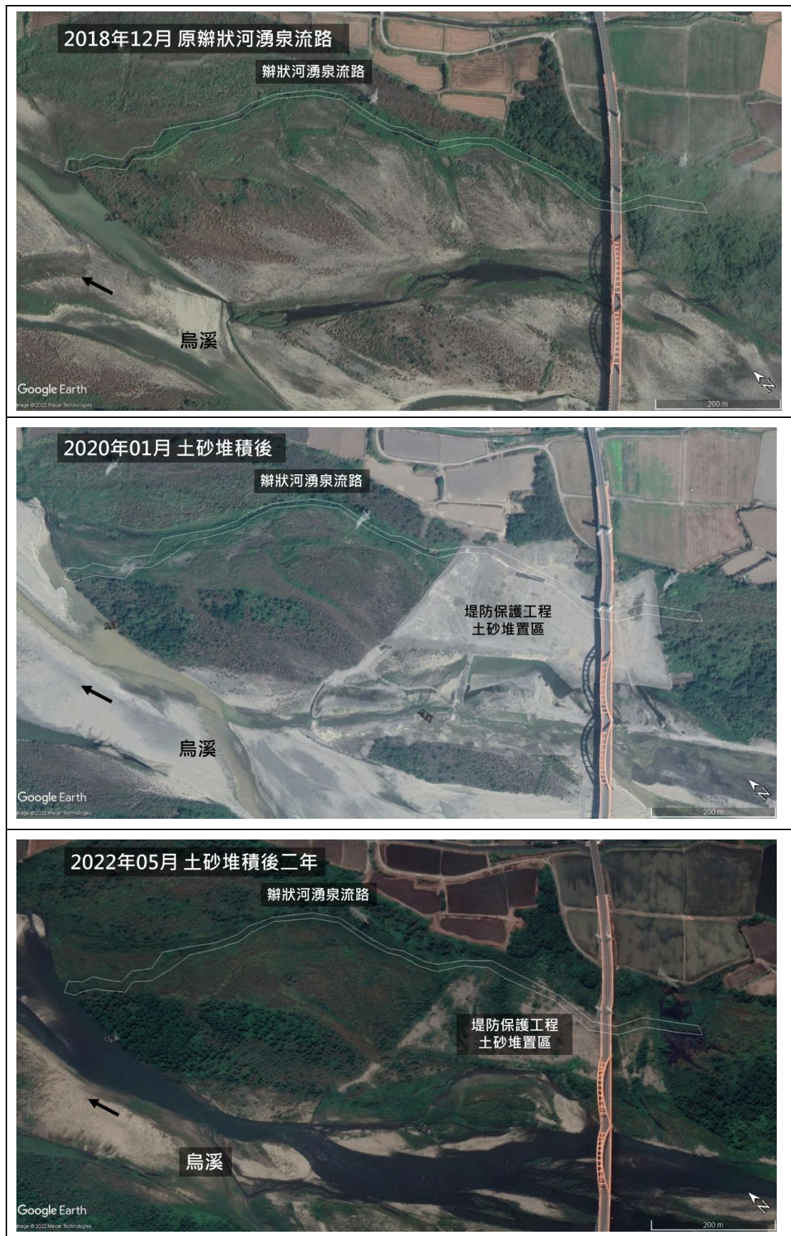
圖 1 烏溪北岸原辦狀河湧泉流路及工程砂石堆積後衛星圖
