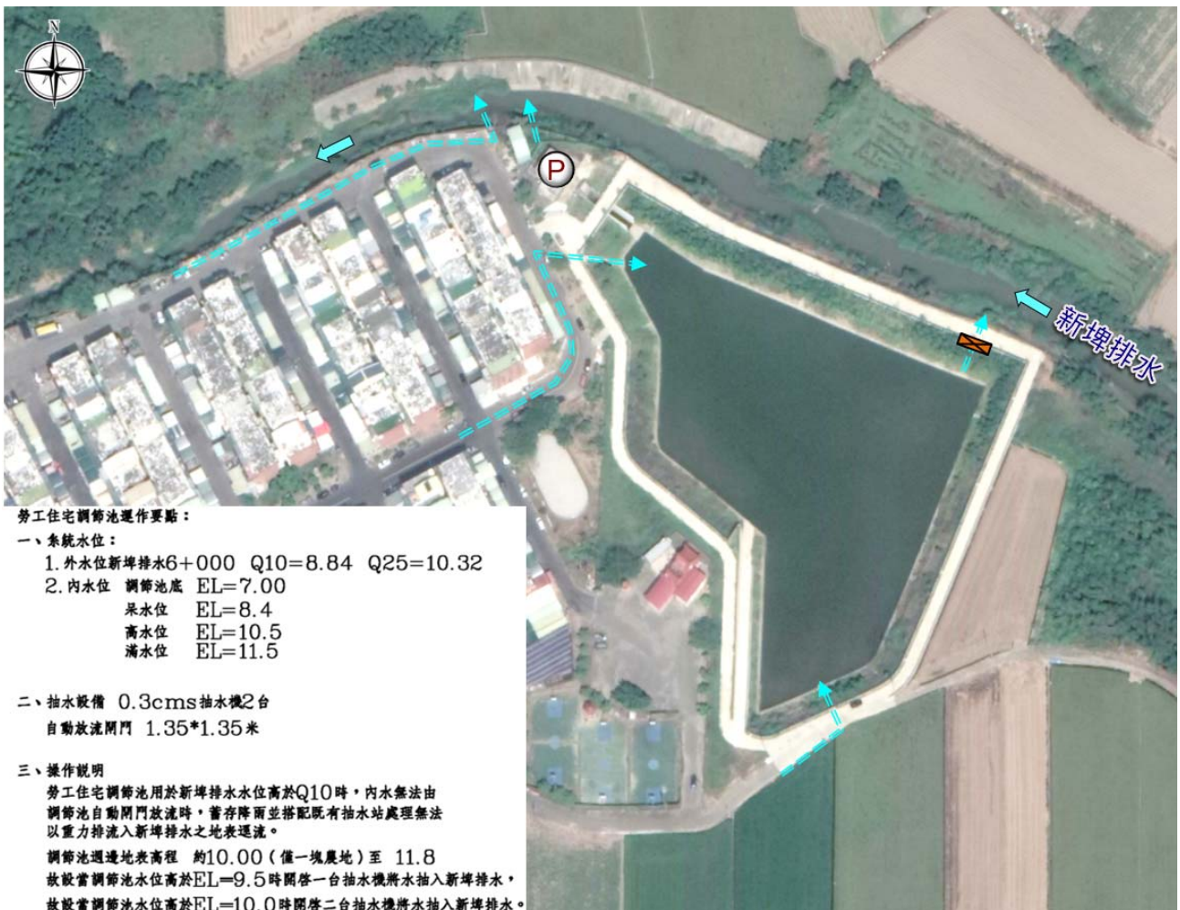
圖2-2-6 勞工住宅抽水站及調節池
