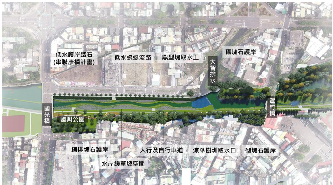
圖6-6-1 國光橋~鷺村橋平面配置示意圖
