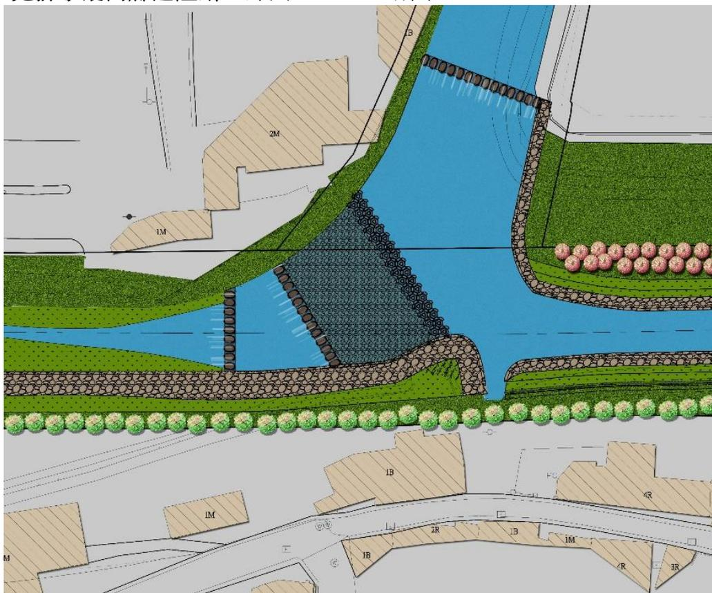
圖6-6-3 取水工平面配置示意图
