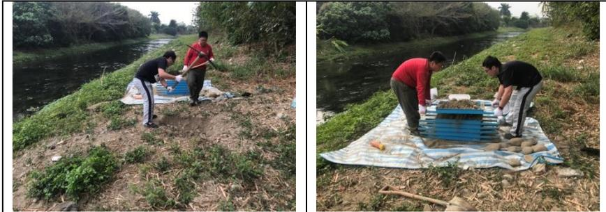
圖4-3-2 野外採樣篩分析試驗過程
