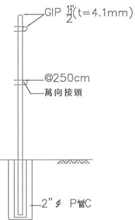
安全護欄側面示意圖（開挖處）
