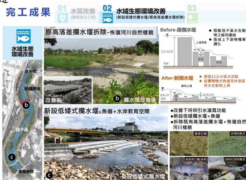
初步提出對各細部課題之改善措施如下：對落差過高之橫向構造物可進行低矮化調整、建構水道縱向生態廊道；對過於平滑或陡直的縱向構造物可設置動物坡道或增加覆土補植植生；對大量引水之取水工程可評估保留高於生態基流量的水量於河道內；對濱溪帶缺乏或經常性擾動可營造綠廊、於施工時迴避鄰近行水區兩側數公尺內的植被；對溪流底質單一化可模擬自然底質營造或打開封底。然各區位面臨之民生需求與斷鏈情況不同，需因地制宜，研提適用於該區域的優化方案。藍綠網絡之改善常涉及跨領域專業，應聯繫相關單位共同進行改善討論、溝通。期待藉由調整既有工程結構或斷鏈狀況，改善藍綠網絡連結。
