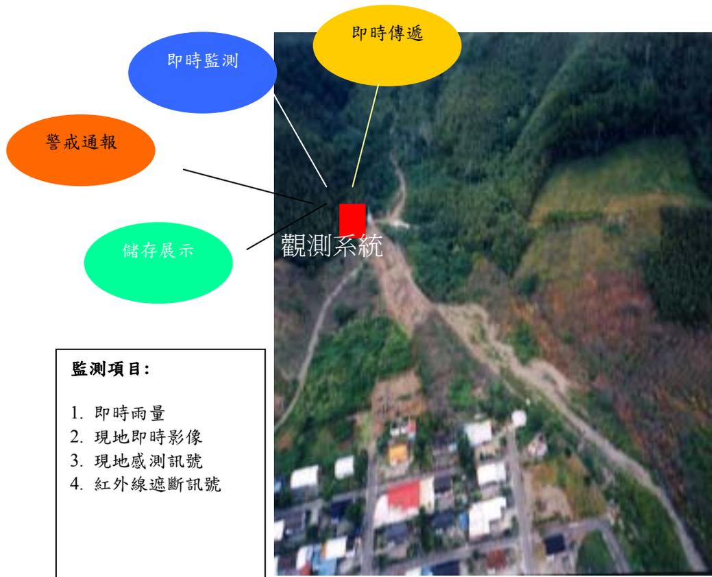
圖 5.3-13 土石流觀測系統架構圖（二）
