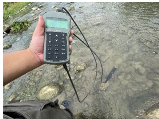
下游站完工後水質測量
