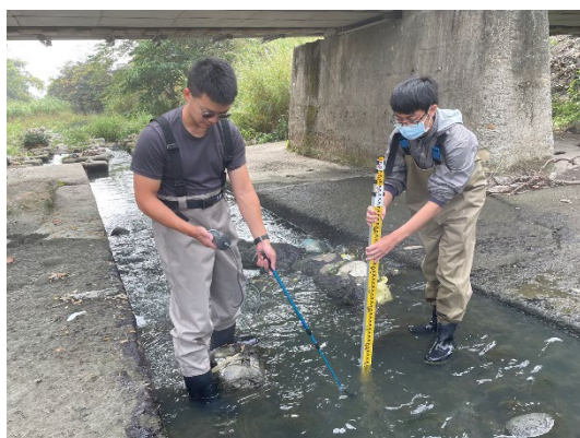
中游站施工前斷面流量測量
