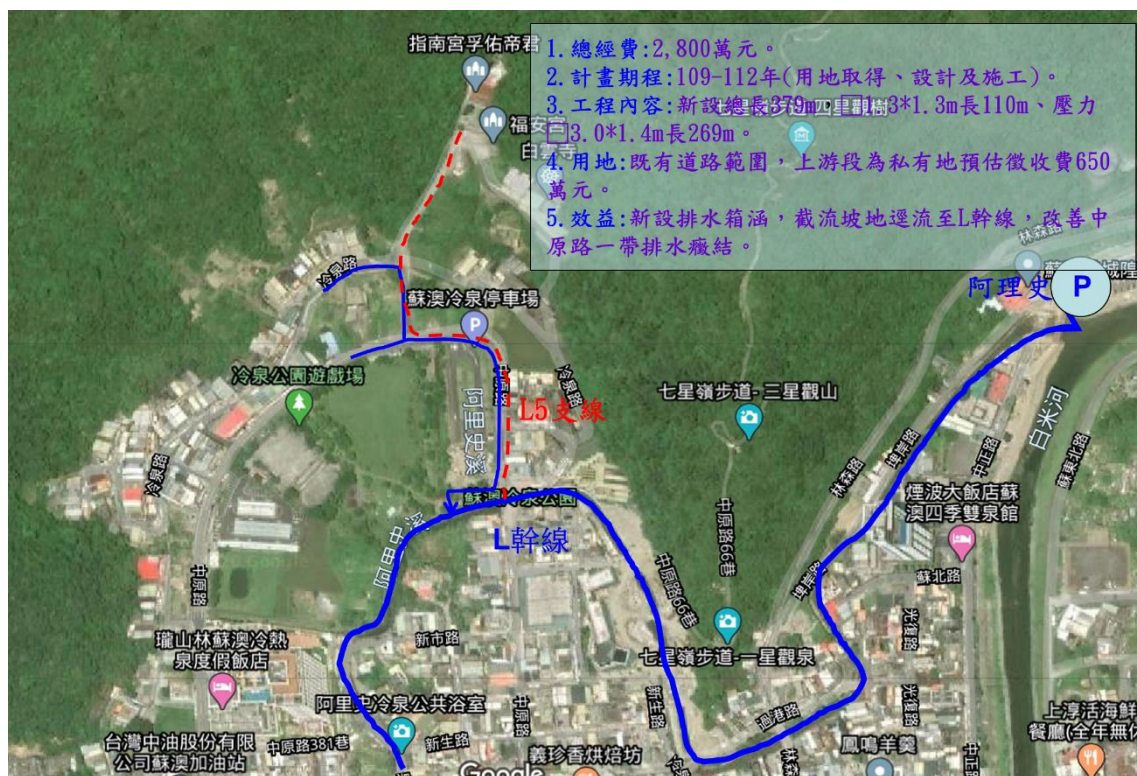
圖 1-7 蘇澳鎮雨水下水道 L 幹線系統圖
