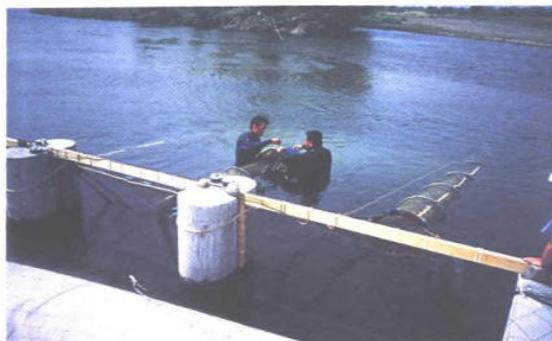
追蹤調查的實施狀況 1(為了要捕捉上溯魚道的魚類，在魚道上游端設置袋網)
