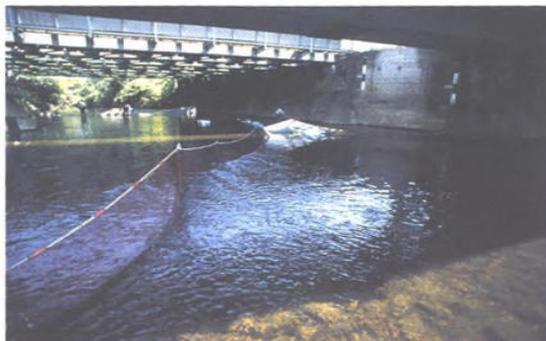
追蹤調查的實施狀況 2(為了要捕捉上溯魚道上的上溯魚，在攔河堰上游設置定置網)
