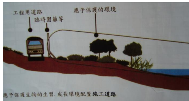
相片 5-1 施工便道迴避生態敏感區域
