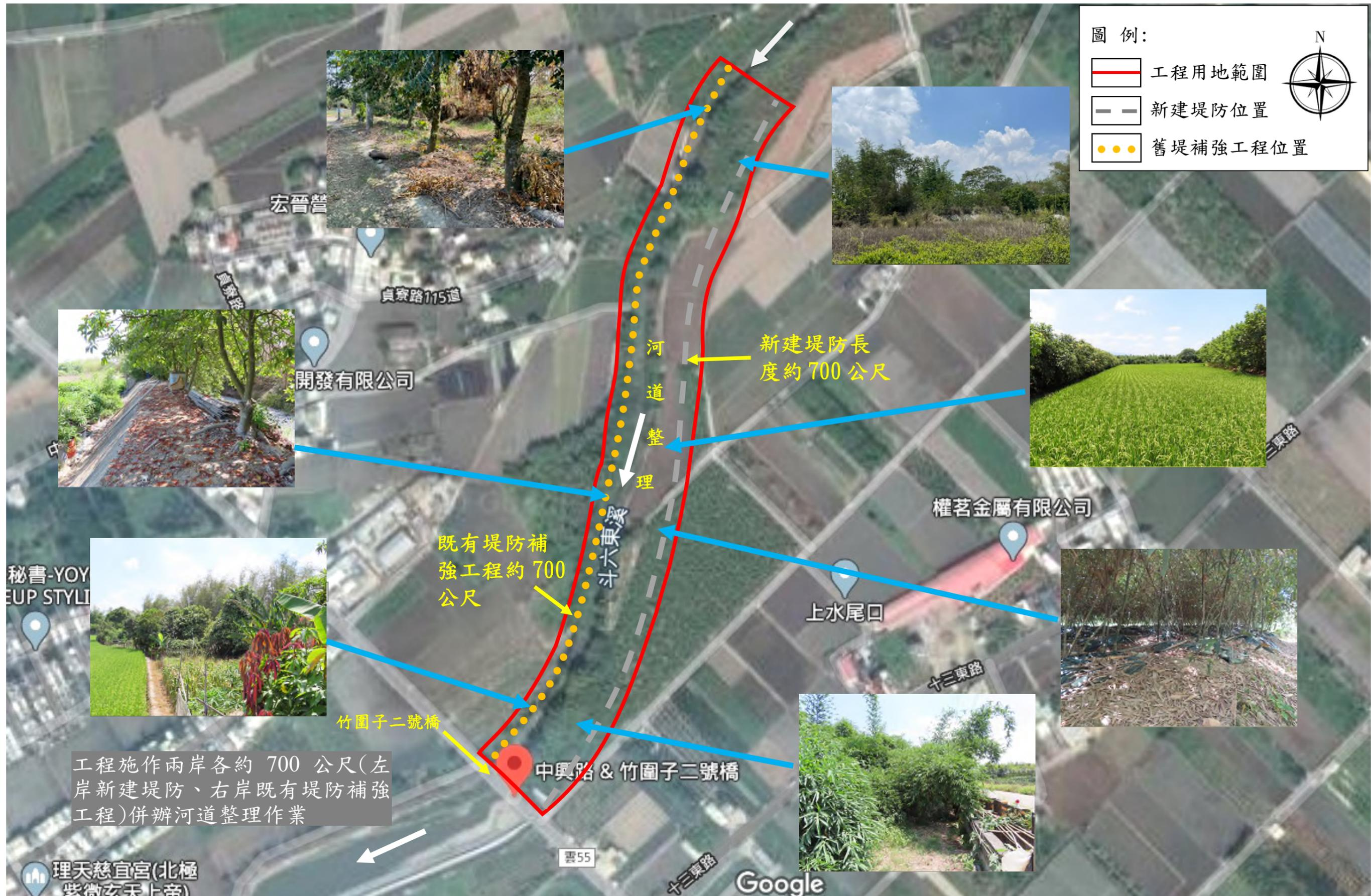
工程施作兩岸各約 700 公尺(左岸新建堤防、右岸既有堤防補強工程)併辦河道整理作業
