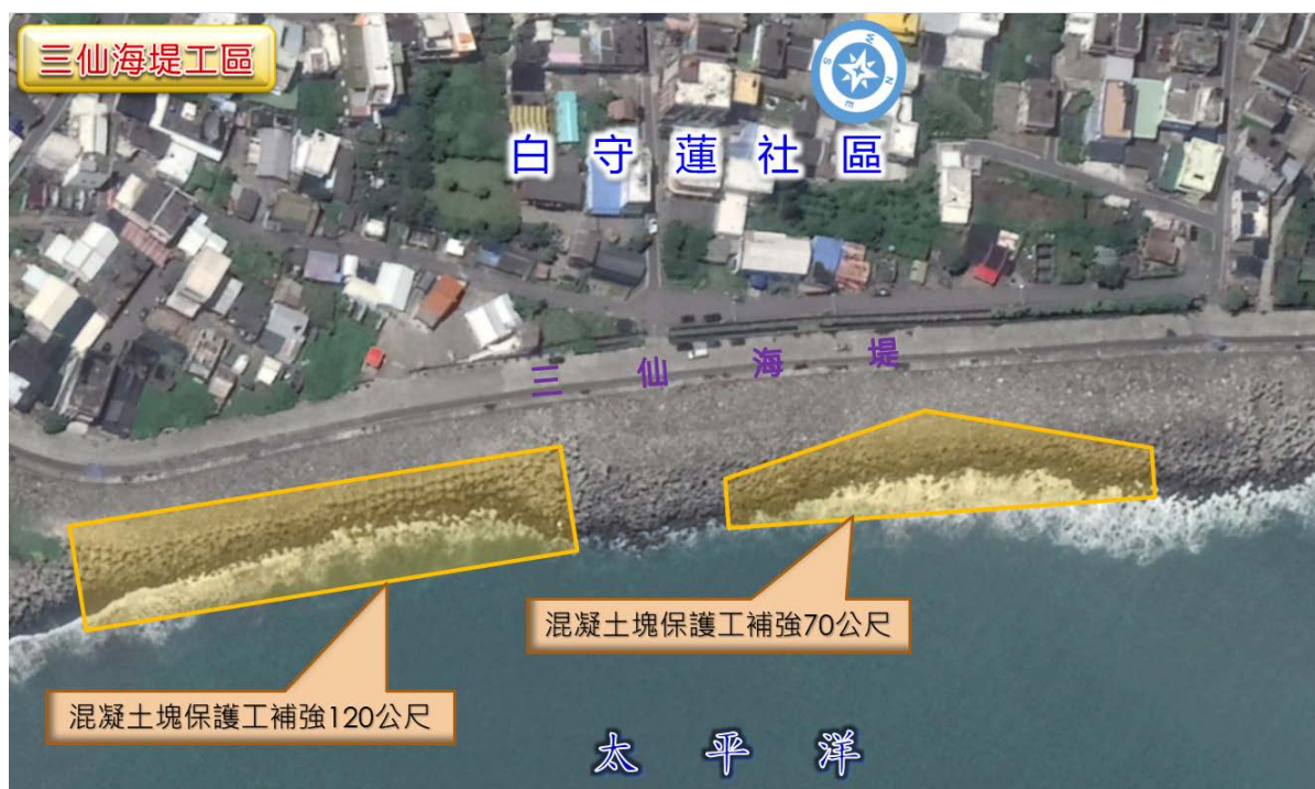
附圖 1-1-1 工程位置圖(三仙海堤工區)
