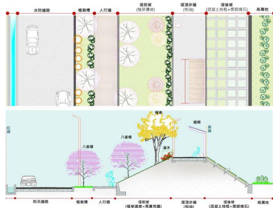
犁頭山堤防工作坊成果： 堤防設施方案平面及剖面圖
