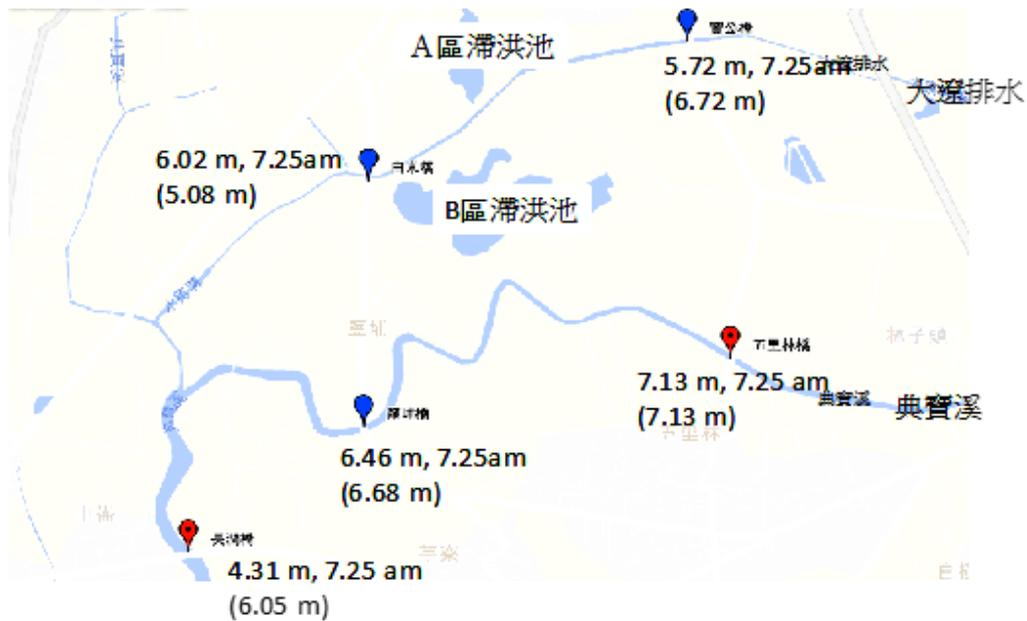
圖 3-111 大遼排水與典寶溪水水位站於 2016/9/28 7.25 am 時之水位；括弧內表示堤防高程
