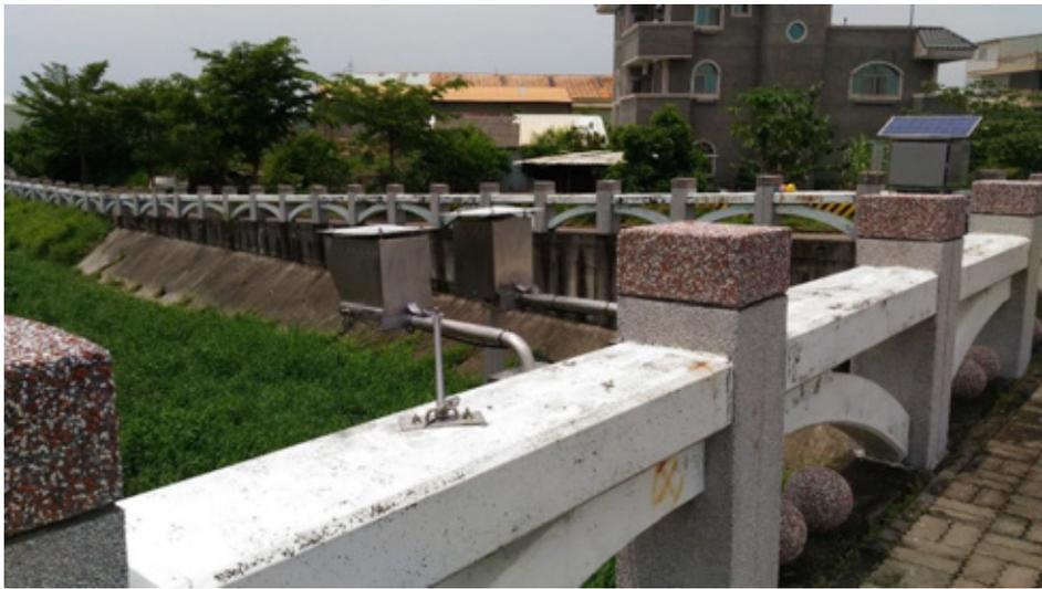
圖 2-20 典寶溪排水集水區白米橋水位計及表面流速計
