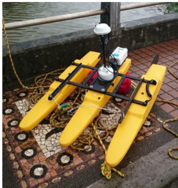
圖 3-20 RiverSurveyor M9 外觀
