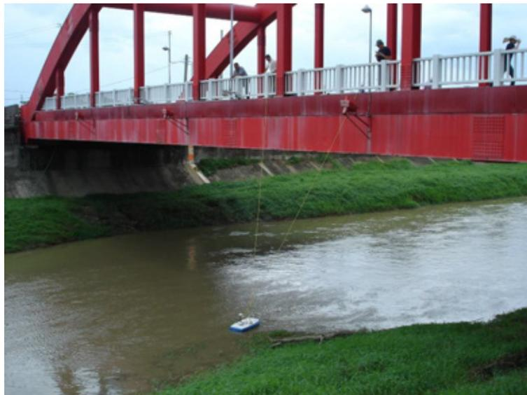
圖 7 RiverSurveyor M9 操作實際狀況：橋面下游側拖曳
