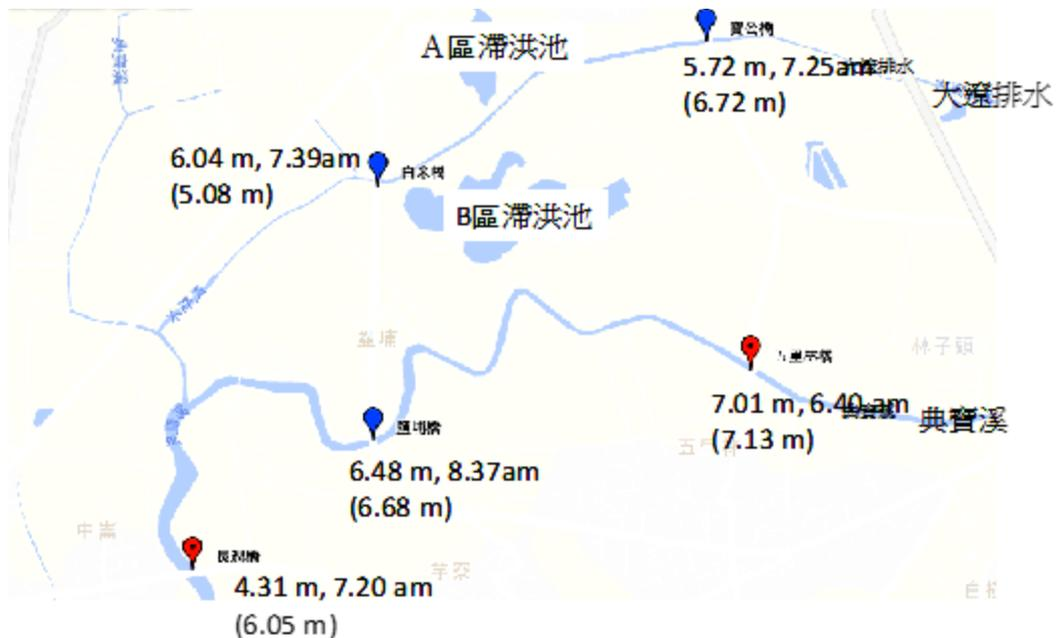
圖 3-110 大遼排水與典寶溪水水位站最高水位及發生時間；括弧內表示堤防高程
