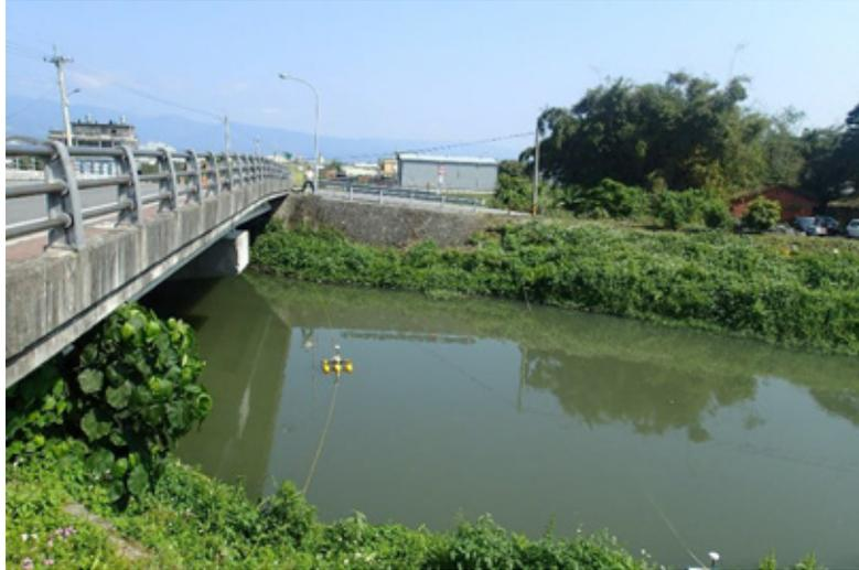
圖 6 RiverSurveyor M9 操作實際狀況：兩岸互拉
