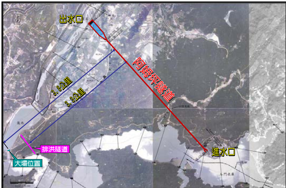
圖 5-2 大壩及排洪隧道距隧道距離示意圖
