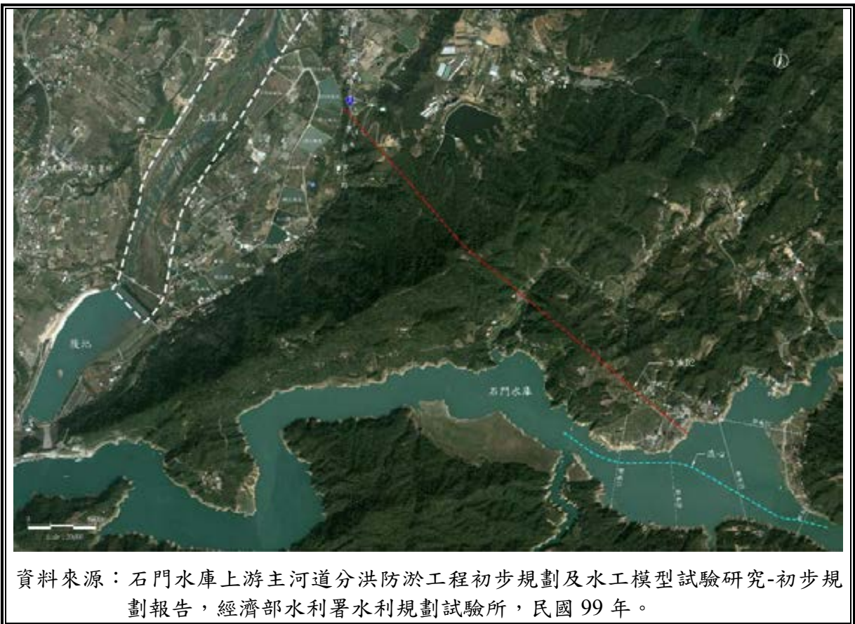
圖 1-2 石門水庫阿姆坪隧道原規劃 D2 方案平面線型圖
