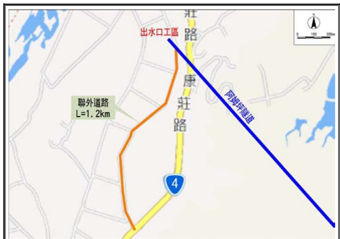
圖 6-42 阿姆坪隧道出水口聯外施工動線
