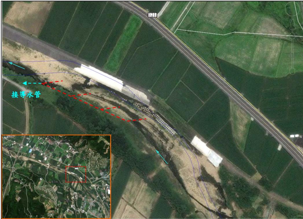
圖 4-3 南勢溪集水管埋設平面示意圖
