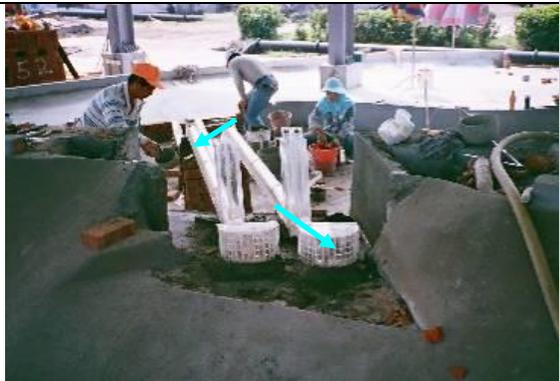
照片 6 排洪隧道壓克力模型組裝
