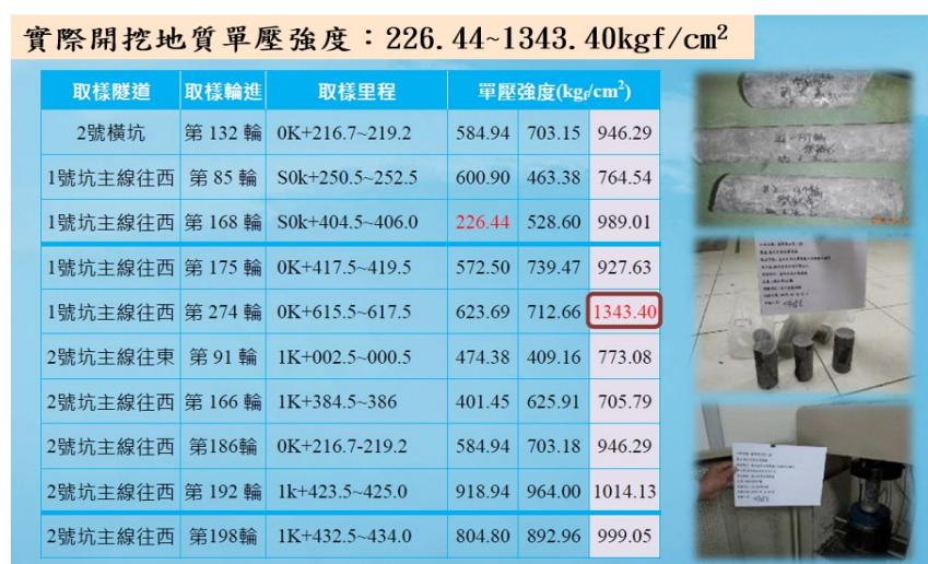
圖 3-4 實際開挖階段岩石單壓強度結果
