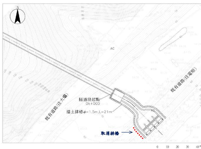
圖 3.3.3-1 原規劃評估之取水口隧道洞口保護平面示意圖
