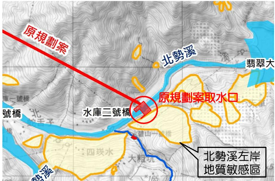
圖 2.2.2-5 原規劃評估之取水口堰址與周邊地質敏感區分布平面圖
