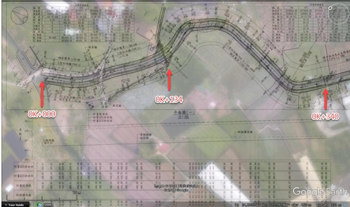
圖 40 OK+000 - OK+340 設計平面配置
