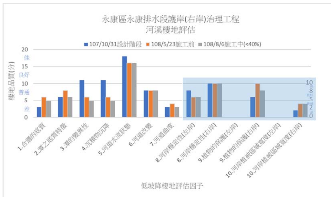
圖 4-59 永康區永康排水段護岸(右岸)治理工程河溪棲地評估結果。
