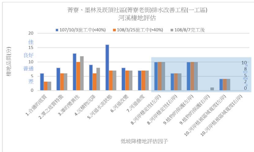
圖 4-35 菁寮、墨林及炭頂社區(菁寮老街)排水改善工程一工區河溪棲地評估結果。
