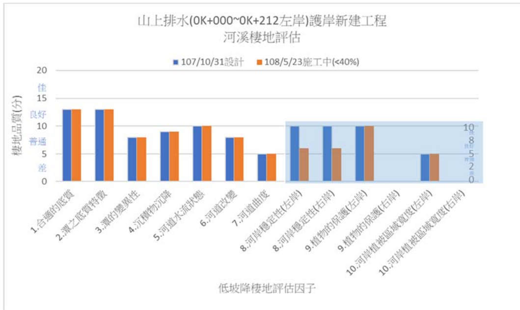
圖 4-44 山上排水(0K+000~0K+212 左岸)護岸新建工程河溪棲地評估結果。
