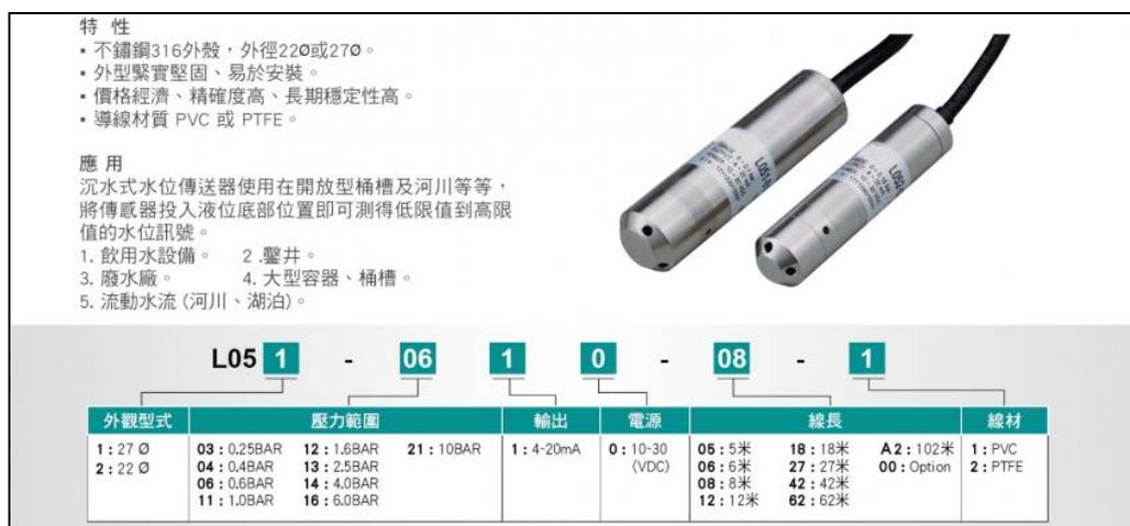
圖 8-2-4 水位計參考規格及示意圖
