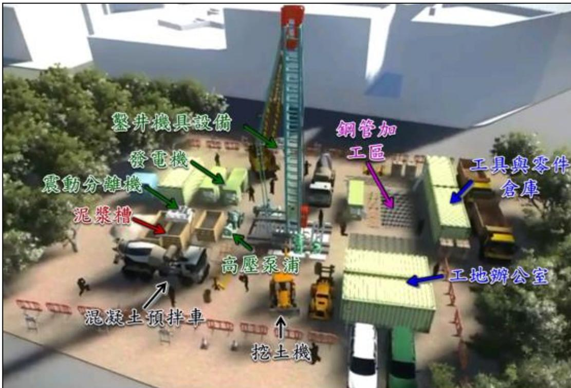
圖 6-3-1 工區機具設備配置示意圖
