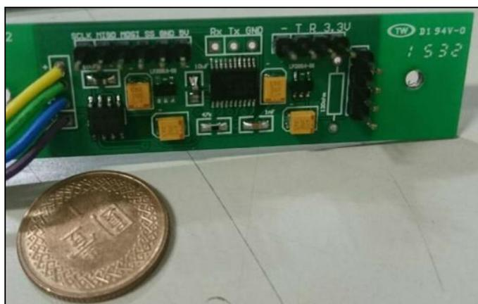
圖 8-2-9 智慧節點(smart node)其尺寸為 74×19mm
