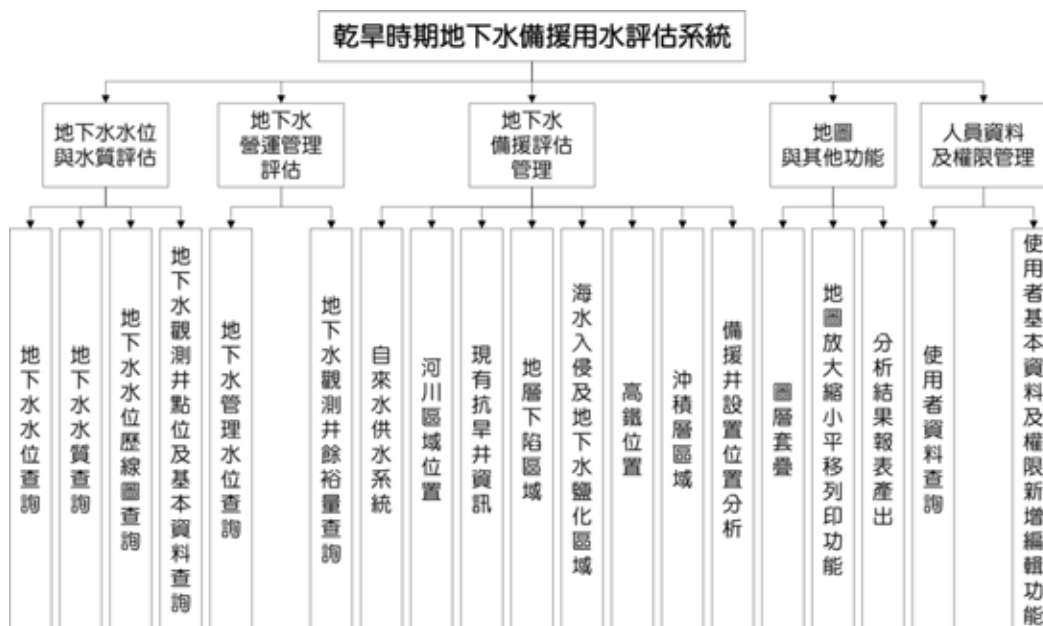
摘圖 8 乾旱時期地下水備援用水評估系統功能架構圖
