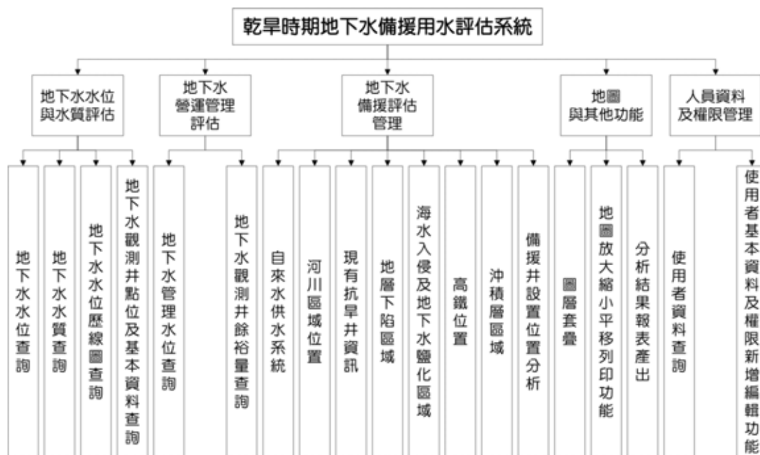
圖 5-2-1 地下水備援用水評估系統功能架構圖
