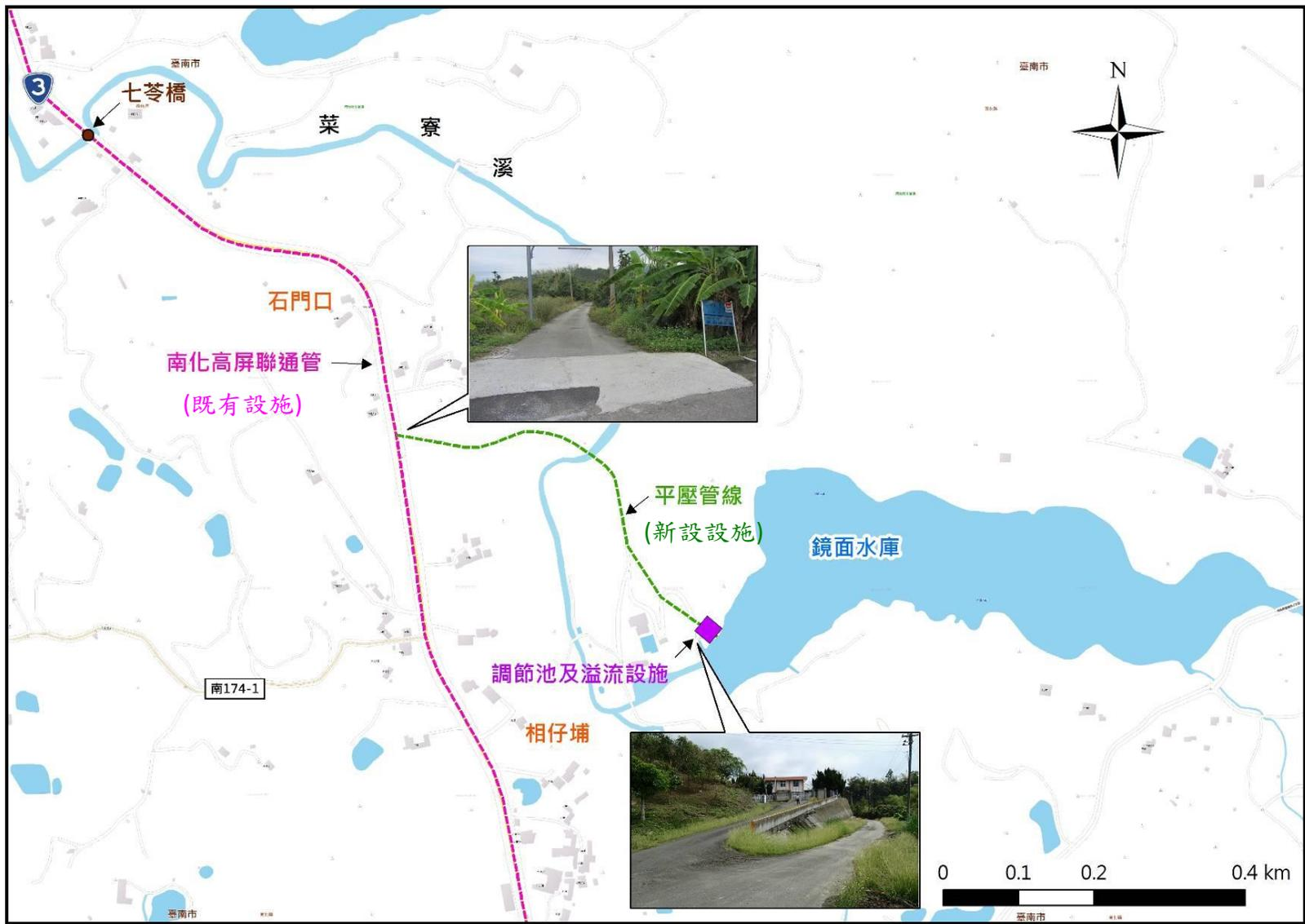
圖 4-6 平壓管路平面佈置圖
