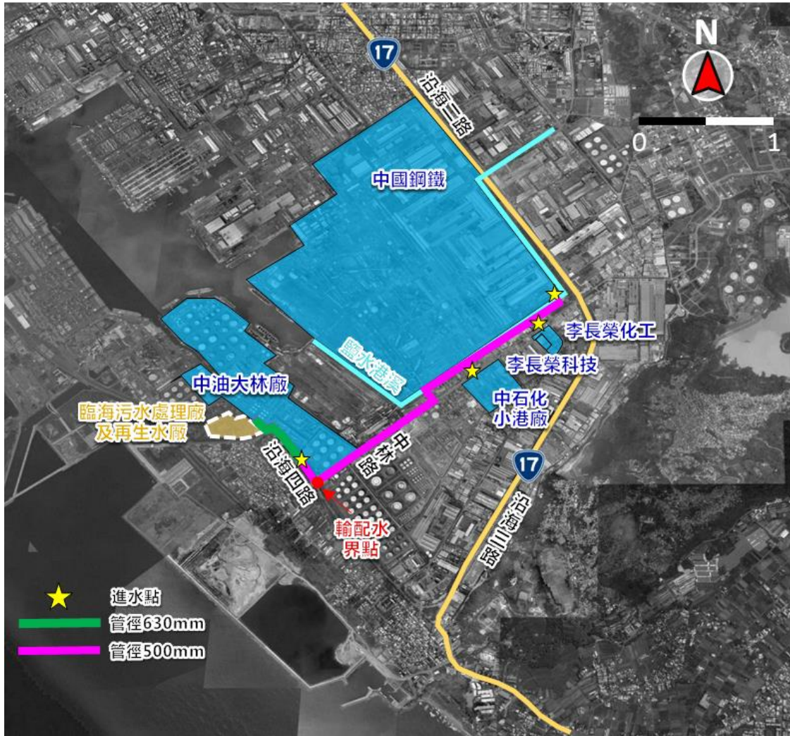
圖 1.4-9 輸配水管線管徑分佈圖
