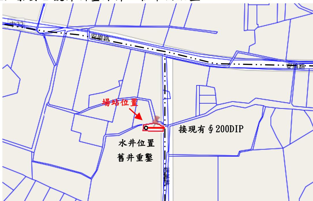
圖 6-2 泰安 2 號井新鑿深井工程平面配置示意圖
