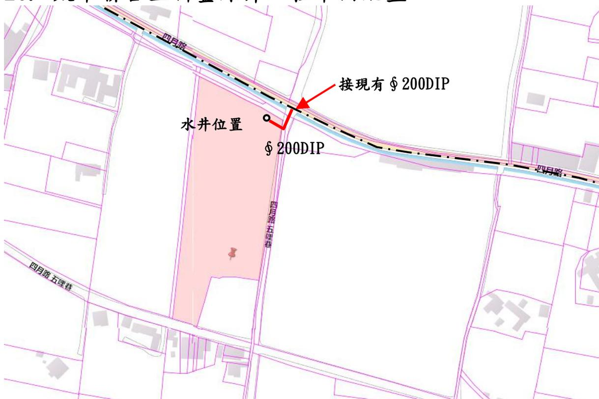
圖 6-26 太平聯合里新鑿深井工程平面配置圖
