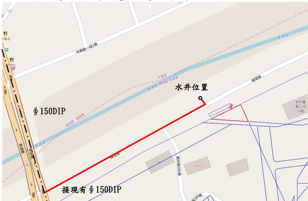
圖 6-19 水利署中水局新鑿深井工程平面配置圖
