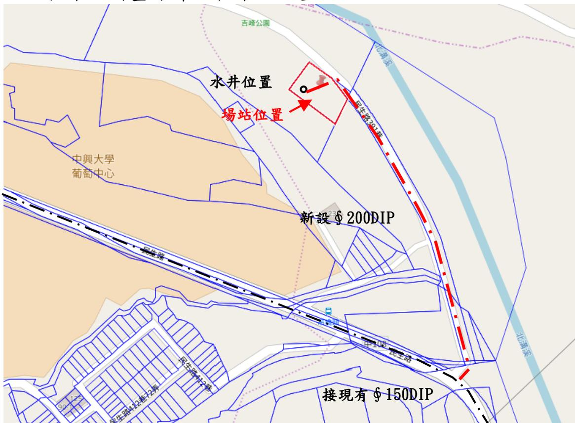
圖 6-4 吉峰里新鑿深井工程平面配置示意圖
