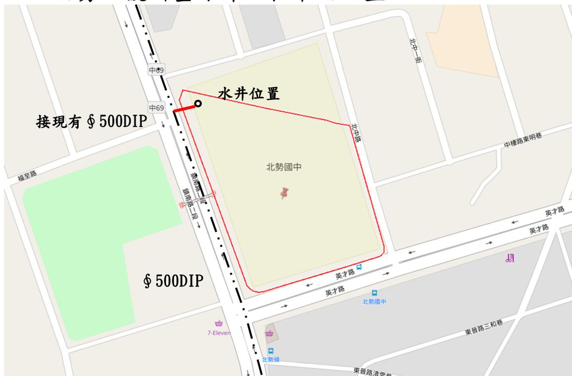
圖 6-15 北勢 1 號新鑿深井工程平面配置示意圖
