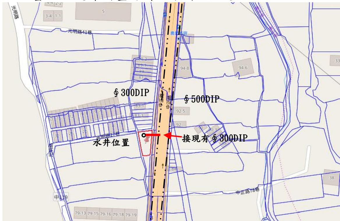
圖 6-20 舊正 3 號井新鑿深井工程平面配置圖
