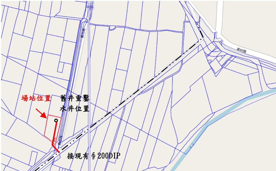
圖 6-3 舊社 4 號整修深井工程平面配置示意圖
