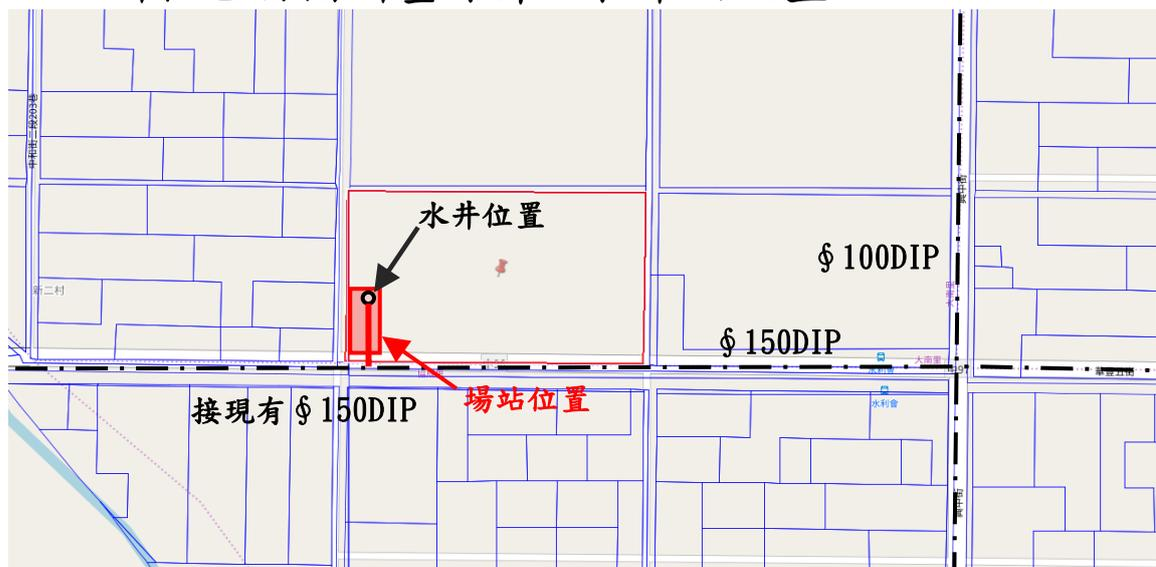
圖 6-13 新社區苗圃新鑿深井工程平面配置示意圖
