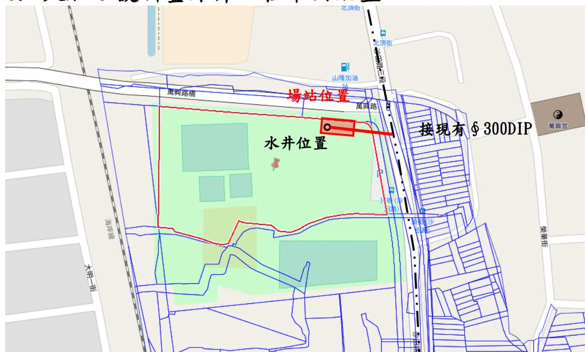
圖 6-6 大肚 5 號新鑿深井工程平面配置示意圖
