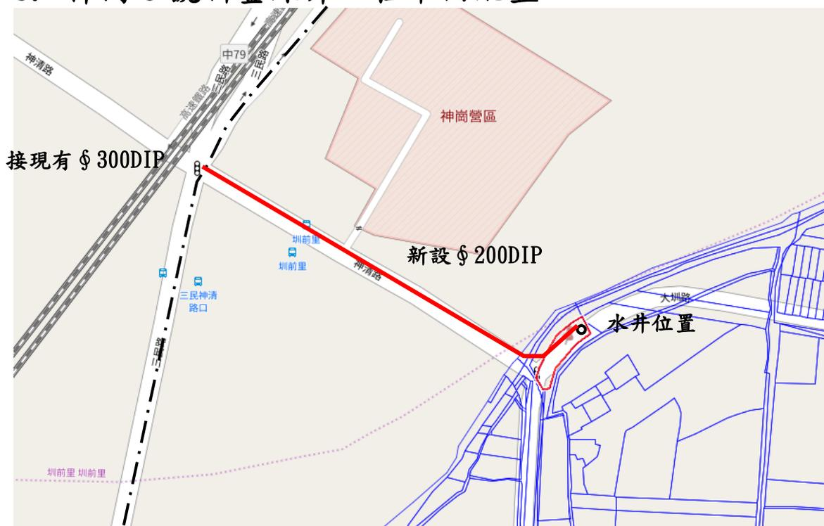
圖 6-5 神岡 3 號新鑿深井工程平面配置示意圖
