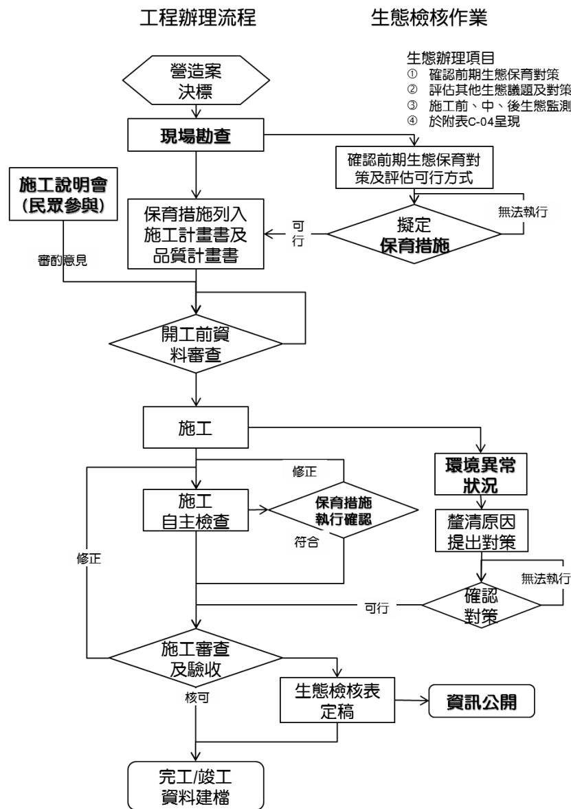
圖 2-2-1 施工階段生態評估流程圖
