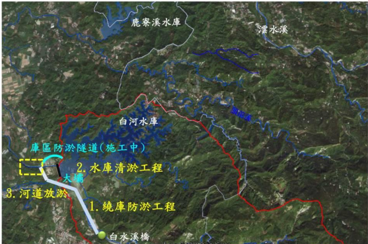
圖 1-1-1 白河水庫後續更新改善工程計畫第一階段工程布置示意圖
