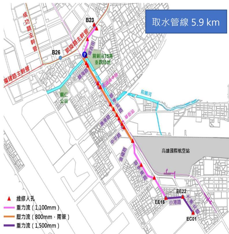
圖 3-4 臨海廠取水管線配置示意圖
