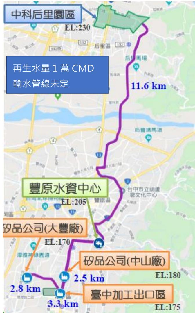
圖 3-8 豐原廠及輸送管線配置示意圖
