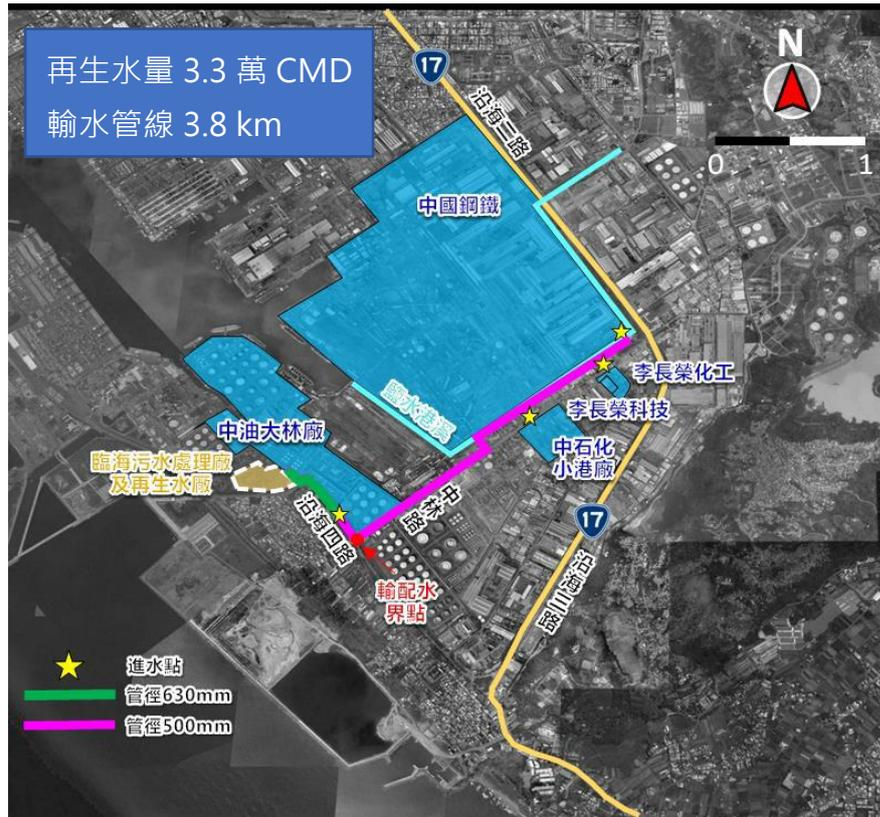
圖 3-3 臨海廠及再生水廠與輸水管線配置示範圖
