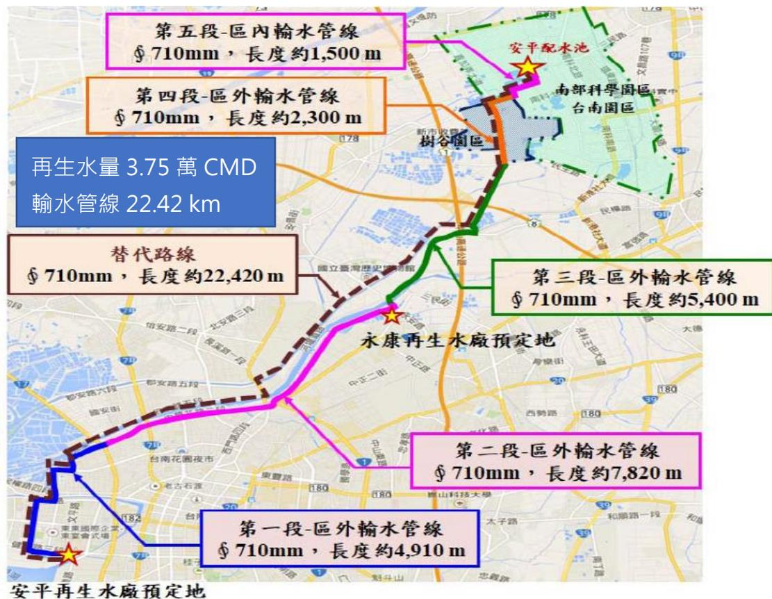
圖 3-6 安平廠再生水設施及輸送管線配置示意圖
