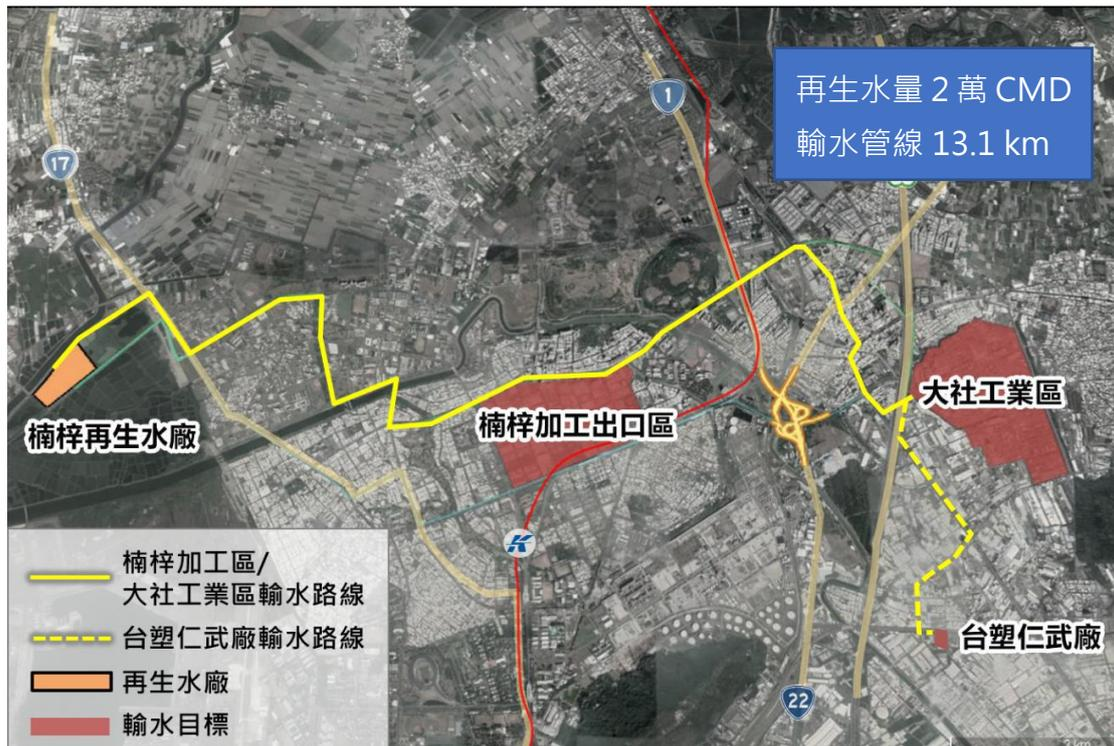
圖 4-3 楠梓廠及輸送管線配置示意圖
