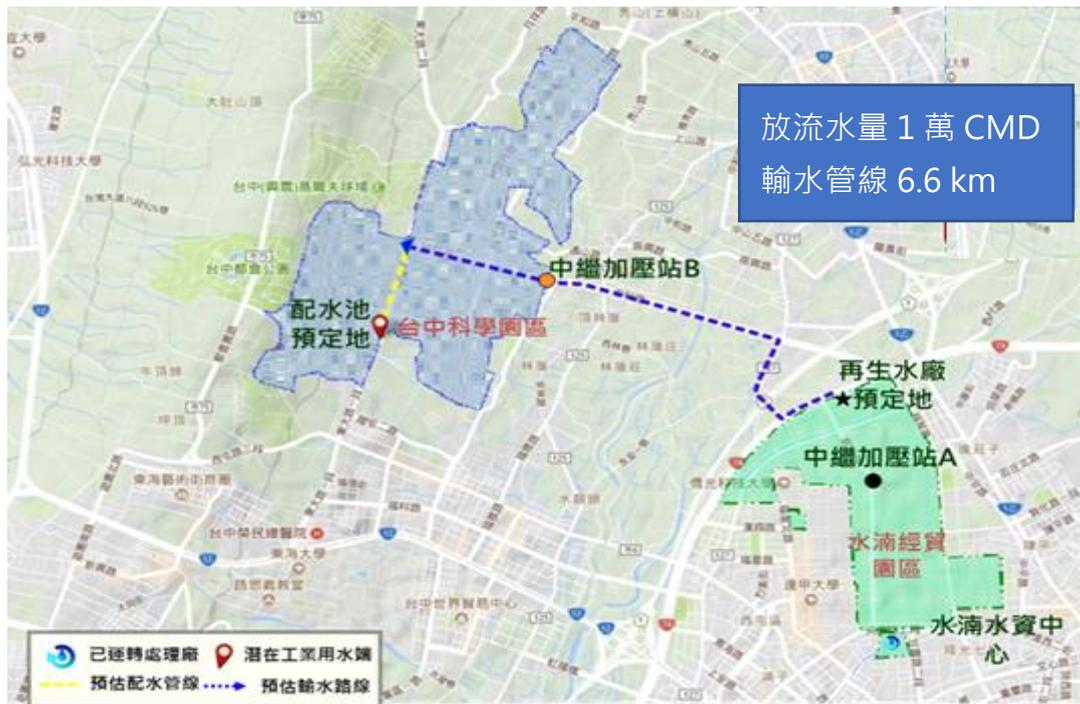
圖 3-9 水湳廠及輸送管線配置示意圖
