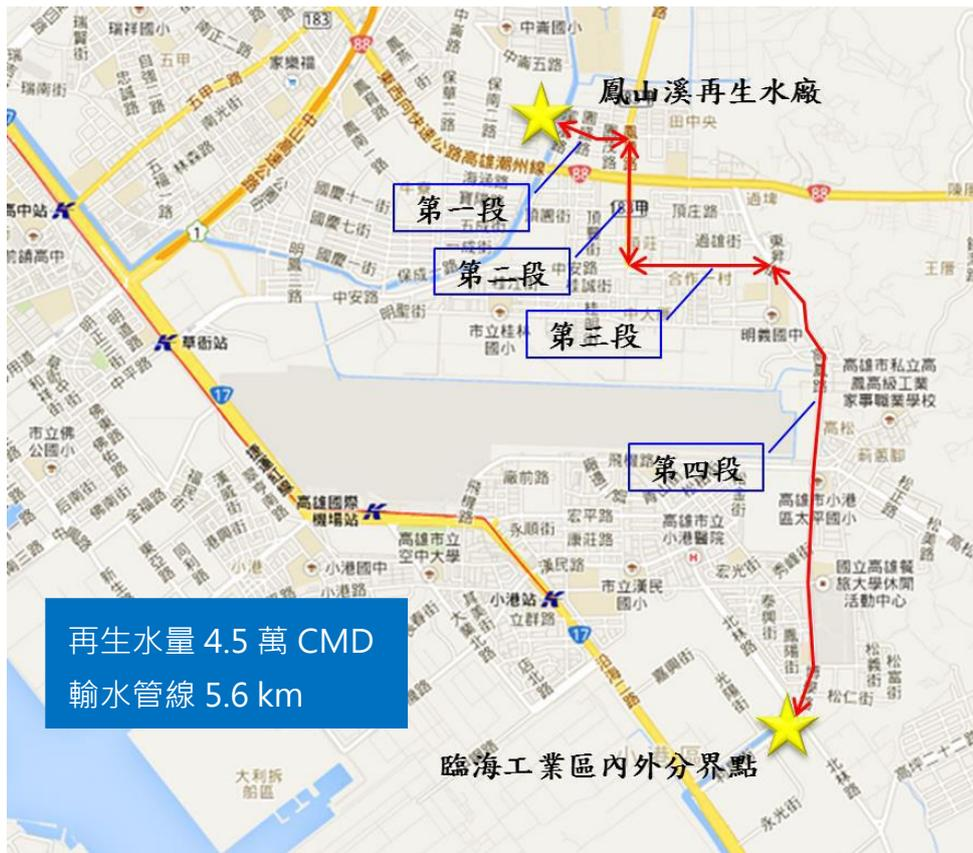
圖 3-2 鳳山廠再生水設施及輸送管線配置示意圖
