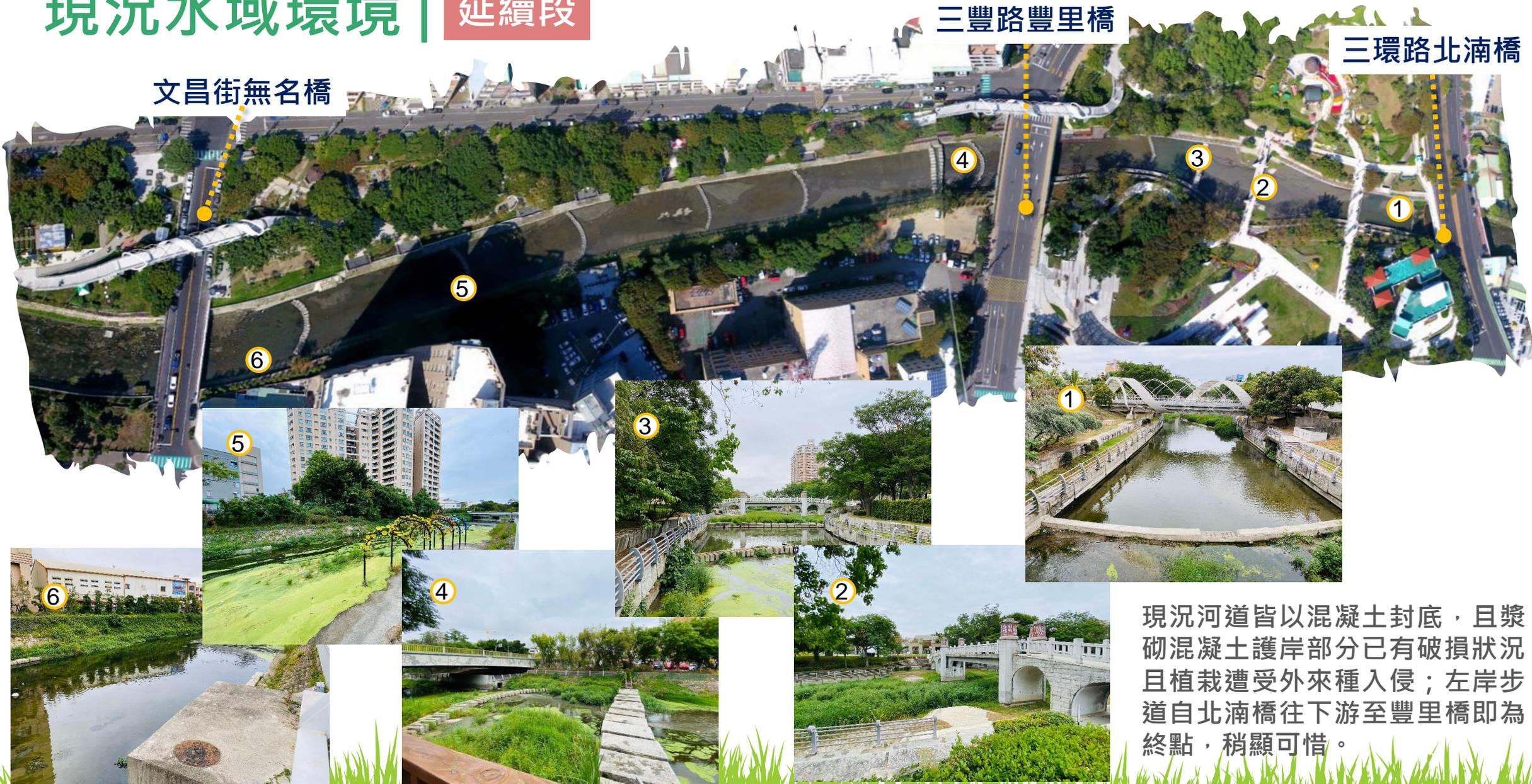
現況河道皆以混凝土封底，且漿砌混凝土護岸部分已有破損狀況，且植栽遭受外來種入侵；左岸步道自北滿橋往下游至豐里橋即為終點，稍顯可惜。
