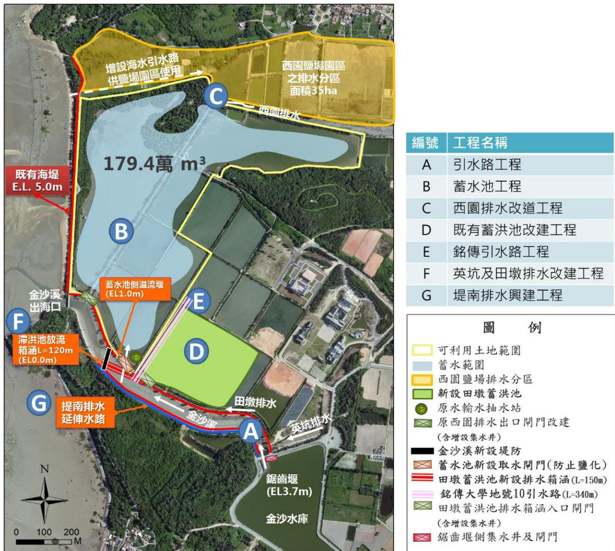
圖 3-28 金沙溪河道設堰取水方案工程布置圖
