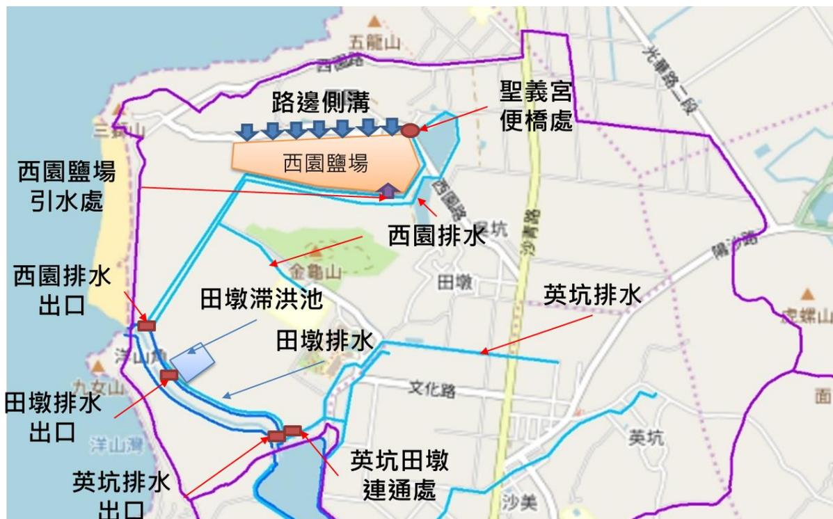
圖 3-24 英坑、田墩及西園排水水流流向示意圖
