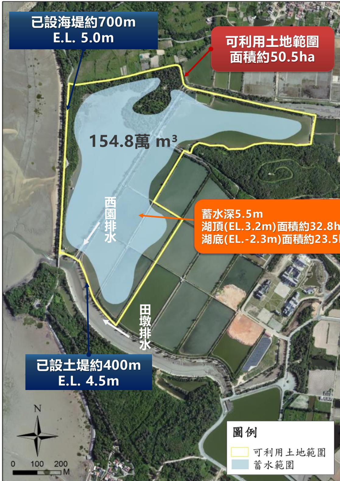
圖 3-16 金沙溪蓄水池初步規劃範圍及水深示意圖(方案三)
