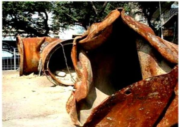
圖 1-3 921 地震自來水管線震害情形
