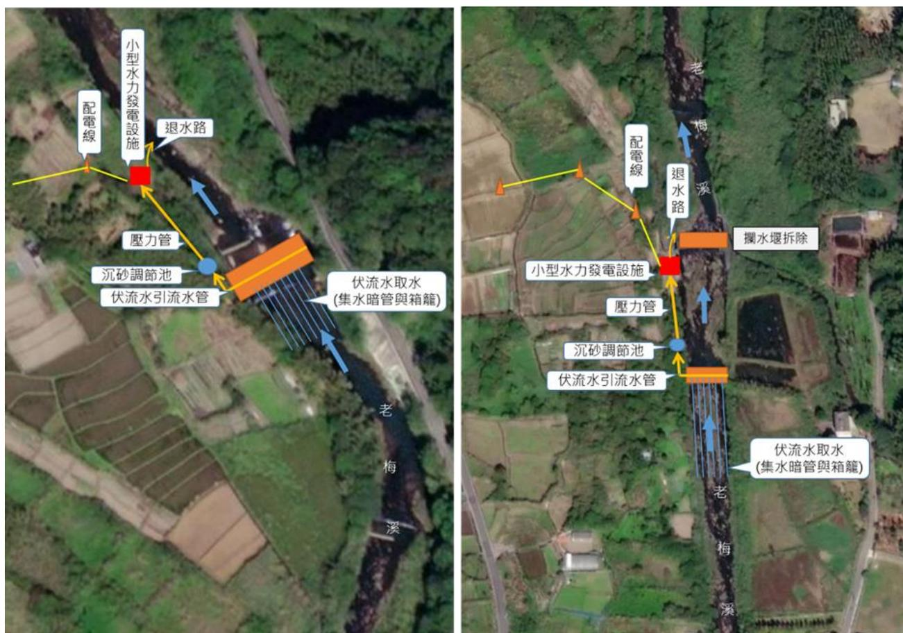
老梅溪小型水力發電工程配置圖
