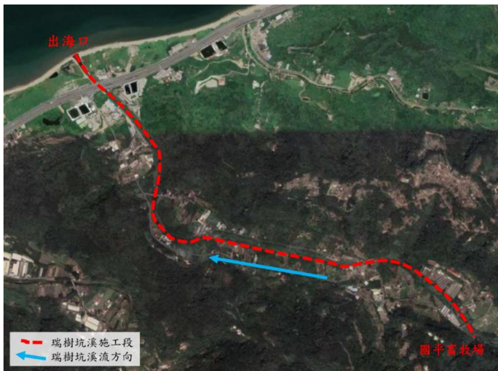
圖 2 瑞樹坑溪畜牧排放水專管設置整體施工段
