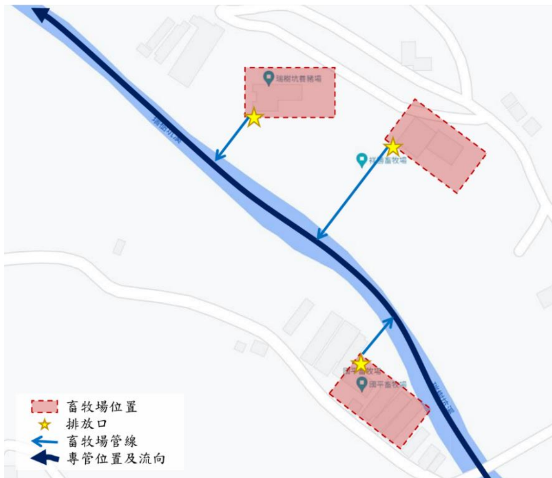
圖 14 瑞樹坑溪畜牧排放水專管設置規劃構想圖-1
